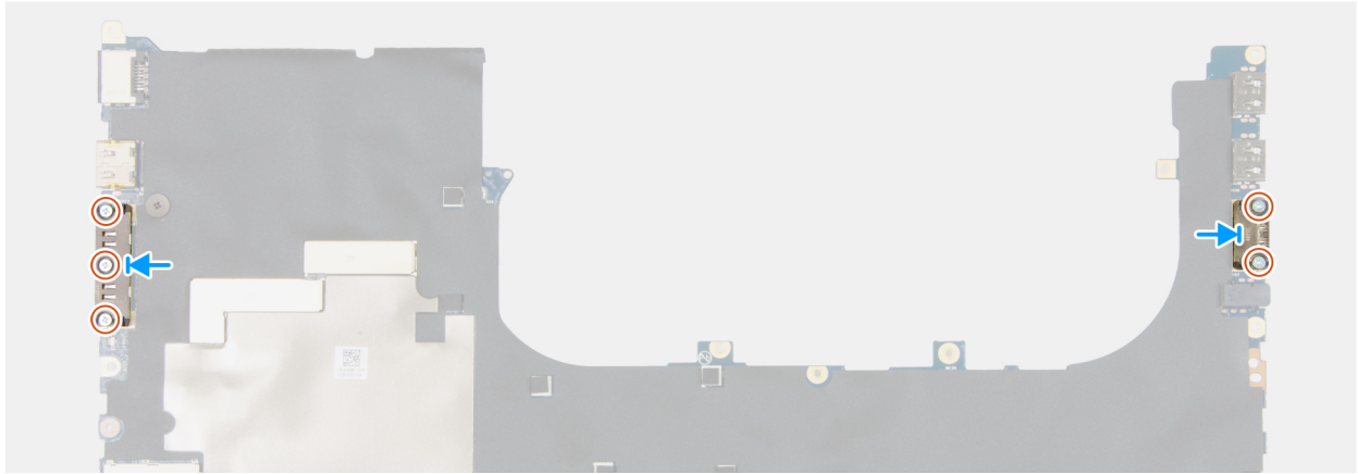
Ilustración 116. Instalación del módulo del conector USB Type-C
