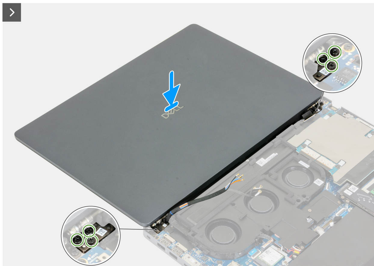
Ilustración 65. Instalación del ensamblaje de la pantalla
