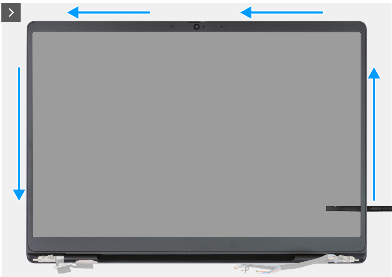
Ilustración 85. Extracción del embellecedor de la pantalla
