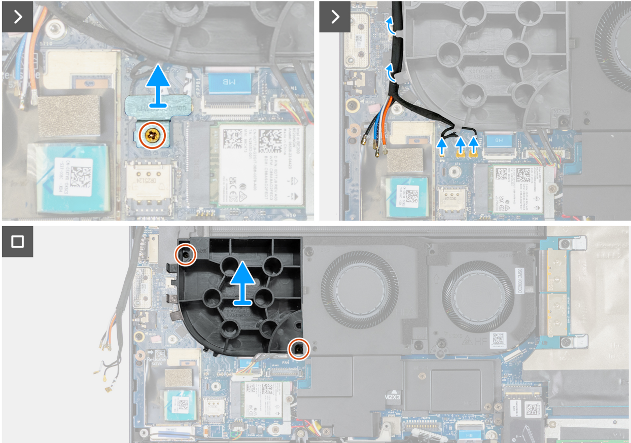
Ilustración 59. Extracción del ventilador ficticio
