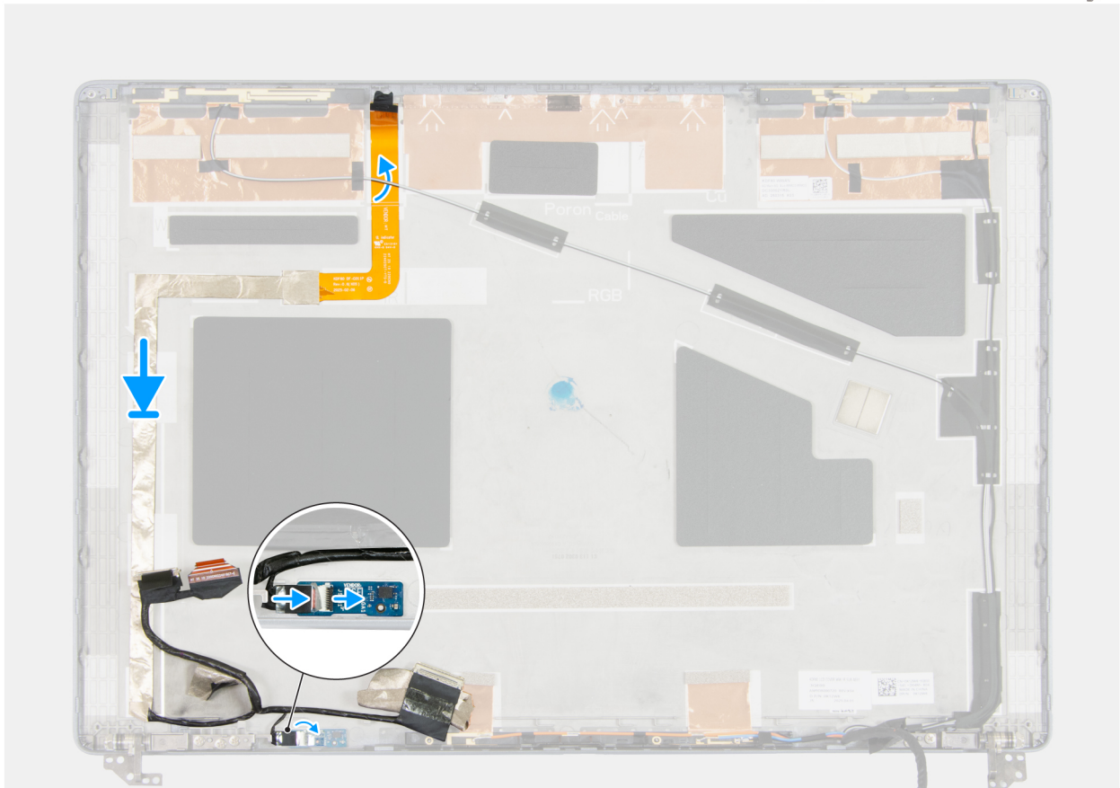
Ilustración 105. Instalación del cable de pantalla
