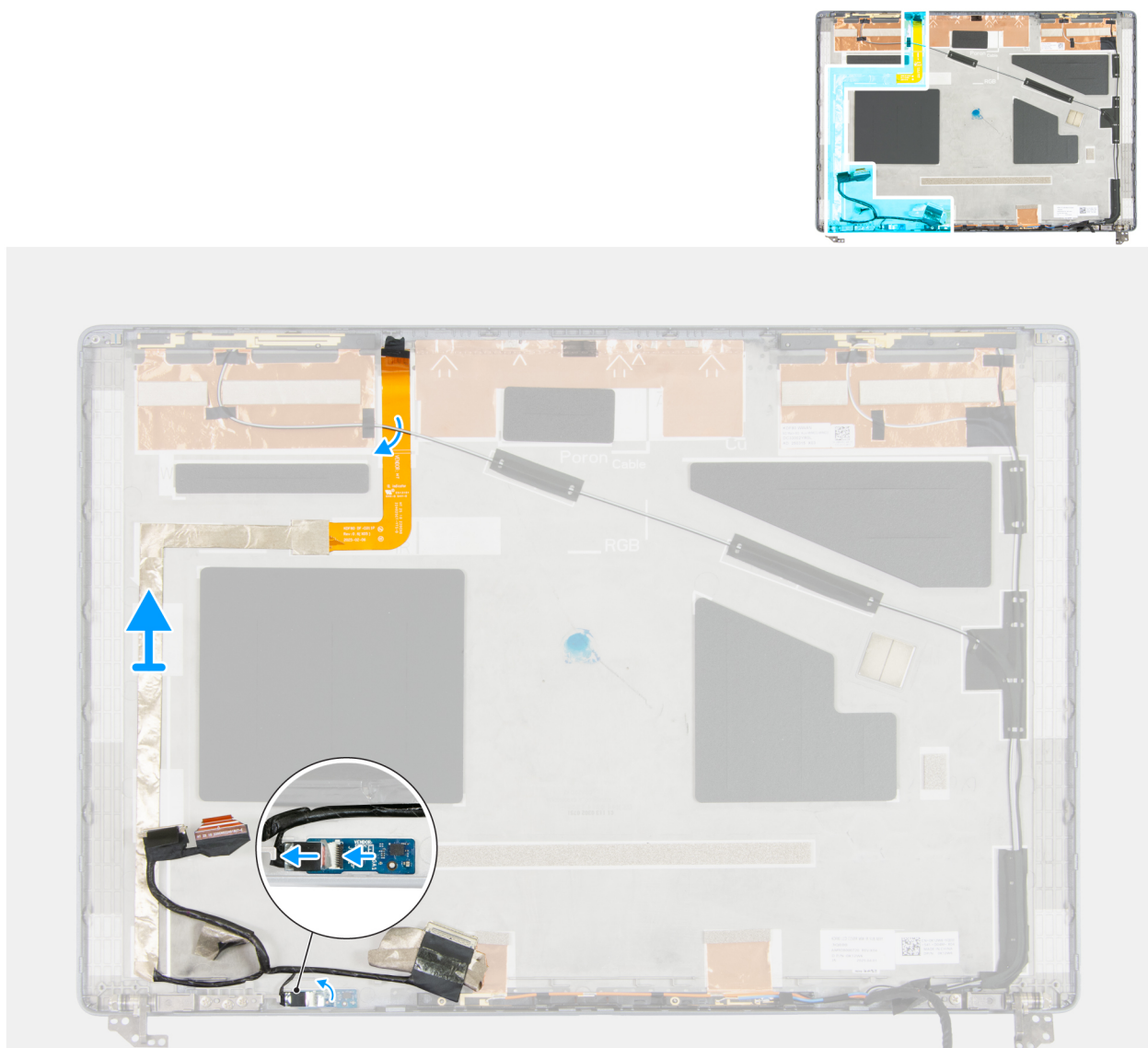
Ilustración 104. Extracción del cable de pantalla
