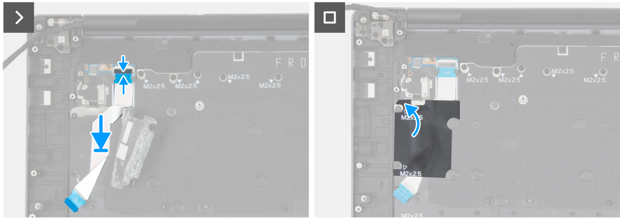
Ilustración 124. Instalación del cable de la placa del botón de encendido
