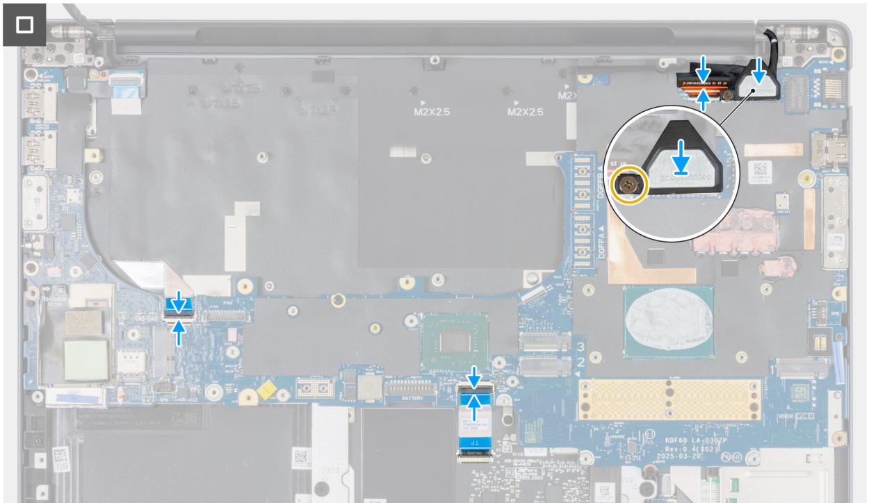
Ilustración 114. Instalación de la tarjeta madre
