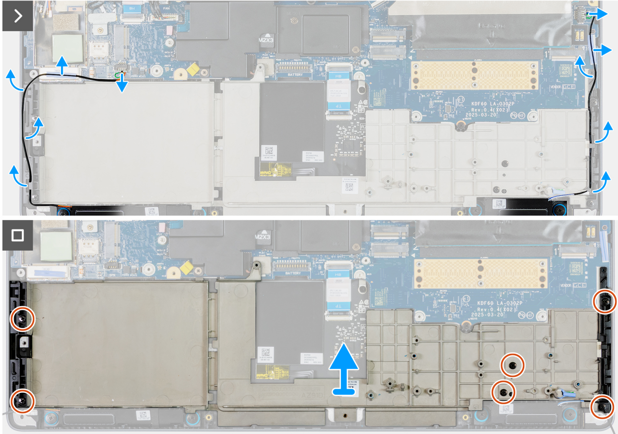
Ilustración 79. Extracción de la trama interna
