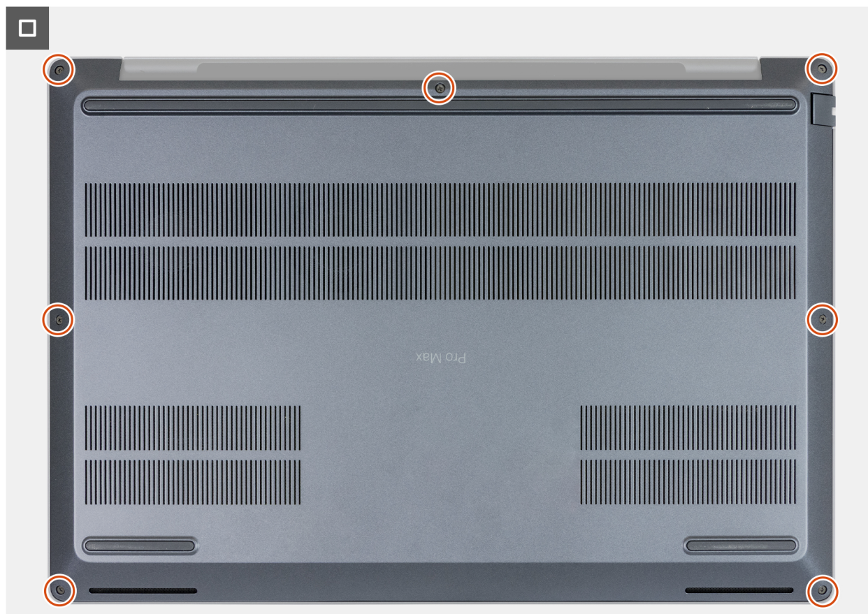
Ilustración 29. Ajuste de los tornillos cautivos
