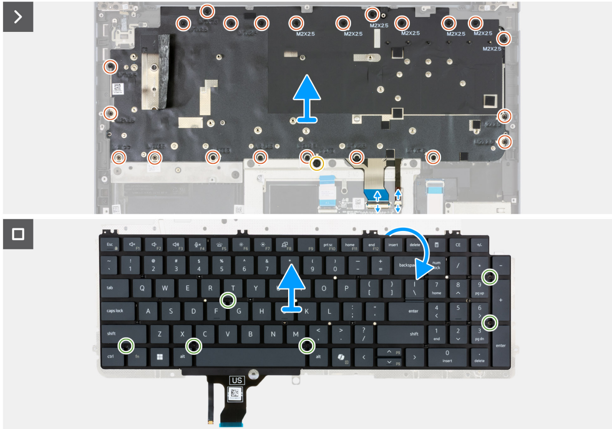
Ilustración 119. Extracción del teclado
