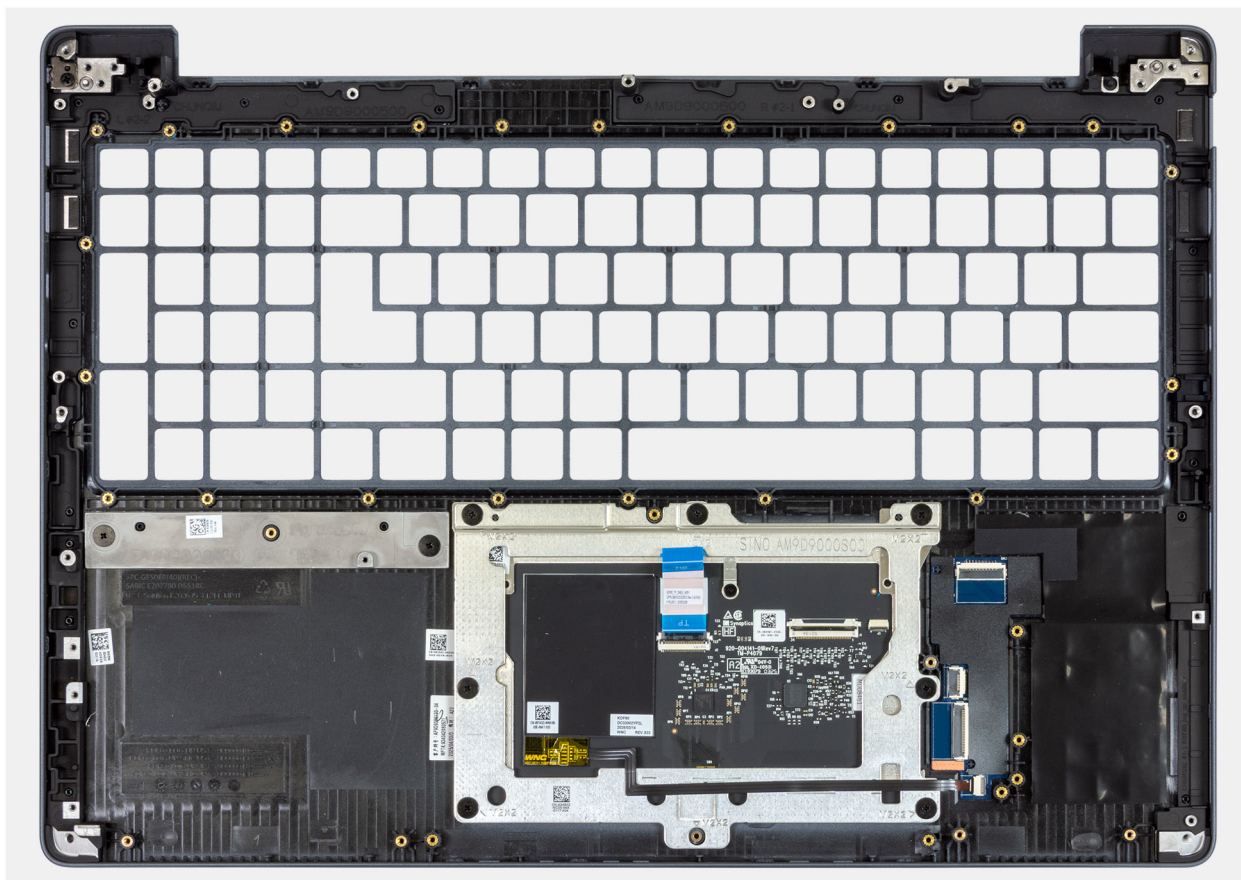
Ilustración 129. Ensamblaje del reposamanos
