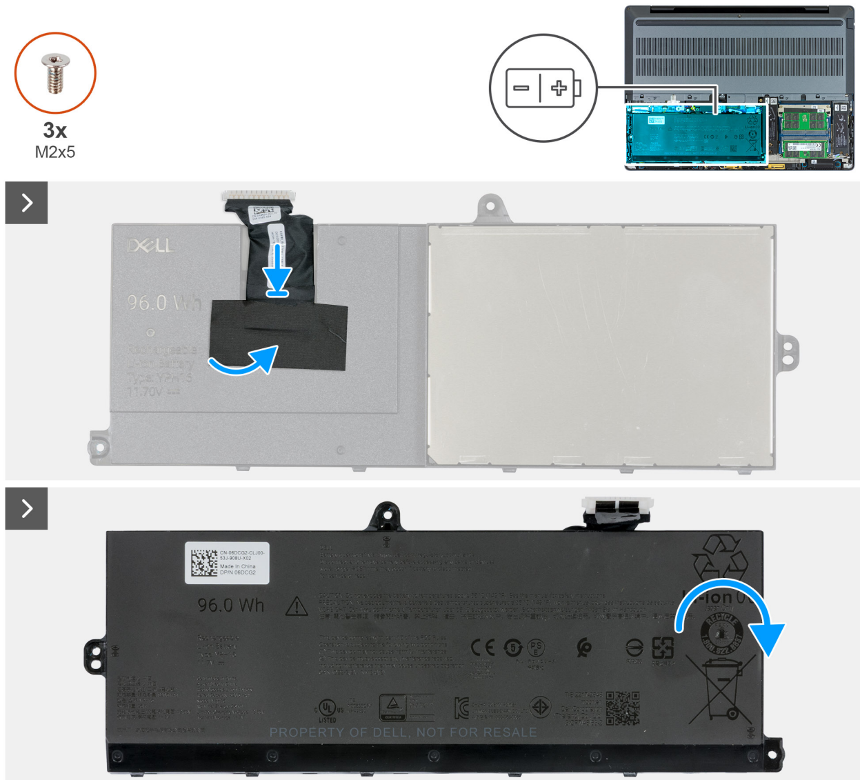
Ilustración 44. Reemplazo del cable de la batería
