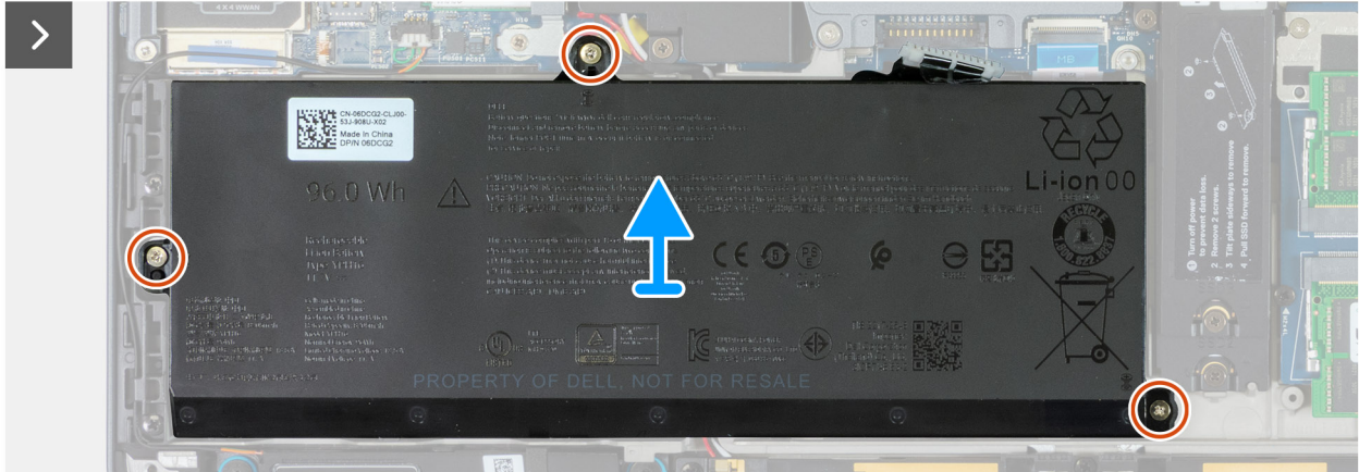
Ilustración 42. Extracción de la batería
