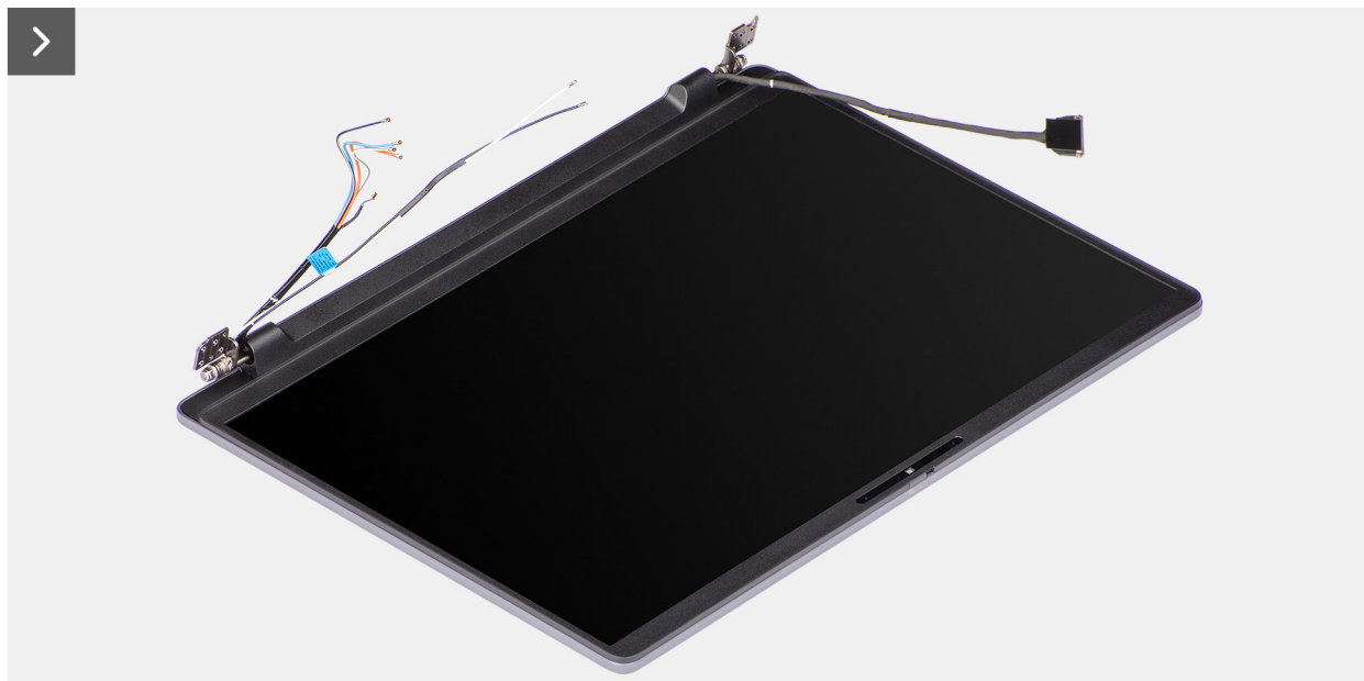
Obrázek 57. Montáž sestavy displeje
