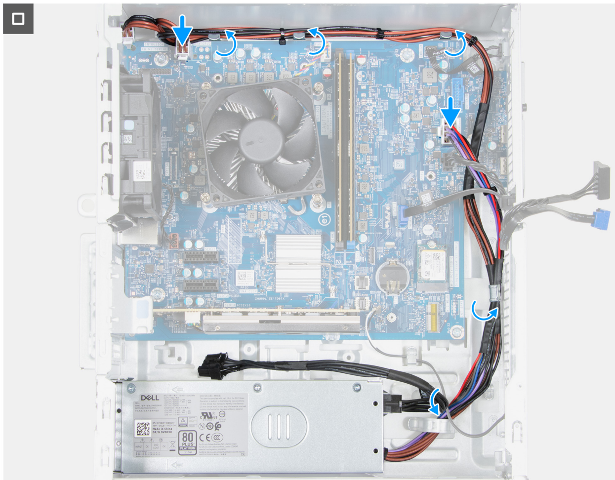
Ilustración 49. Instalación de la fuente de alimentación
