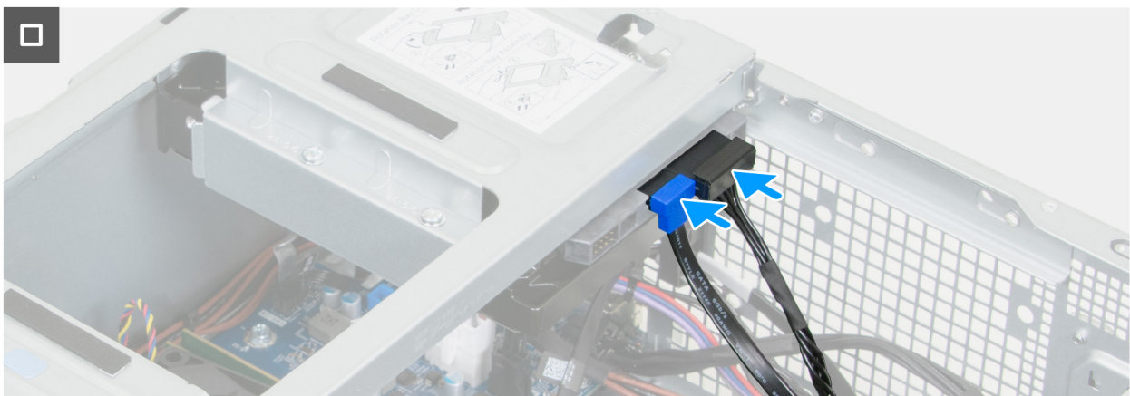
Ilustración 32. Instalación de la bahía de unidad
