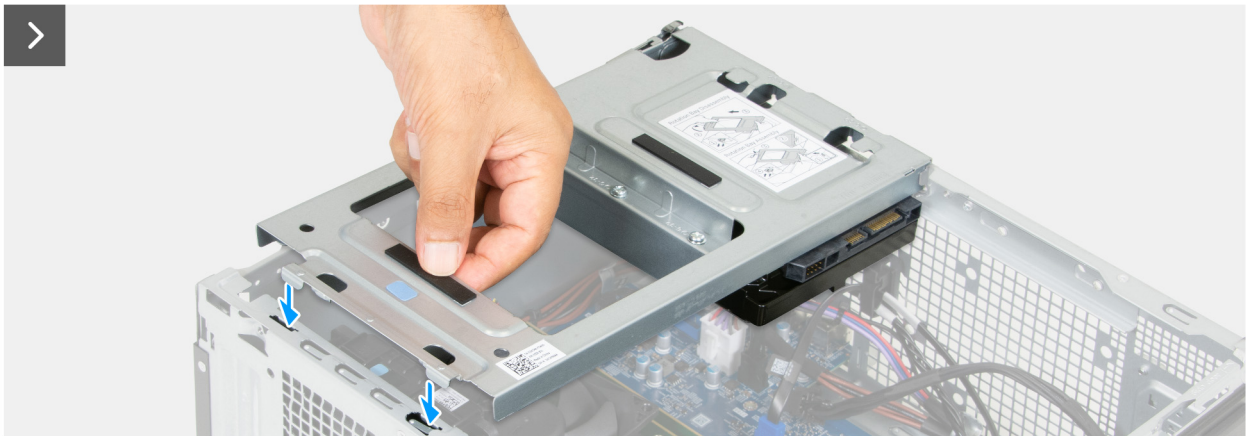
Ilustración 31. Instalación de la bahía de unidad
