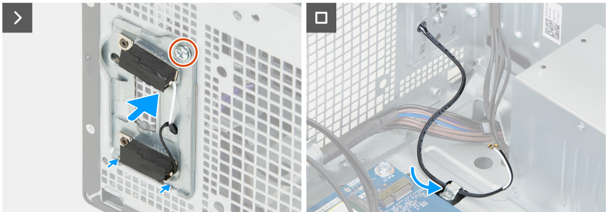
Ilustración 45. Instalación de los módulos de la antena
