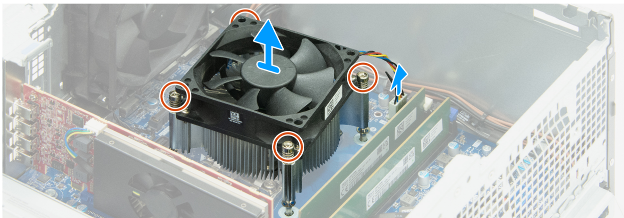
Ilustración 50. Extracción del ensamblaje del disipador de calor y el ventilador del procesador
