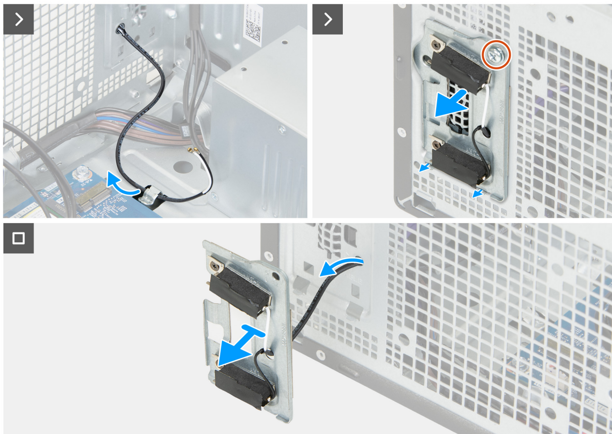
Ilustración 44. Extracción de los módulos de la antena
