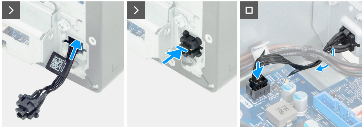
Ilustración 36. Instalación del botón de encendido
