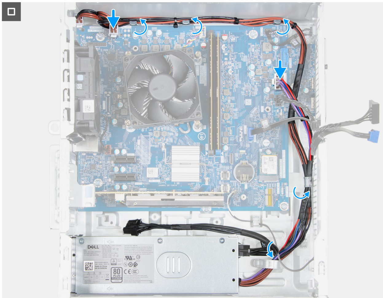
Figure 49. Installation du bloc d'alimentation
