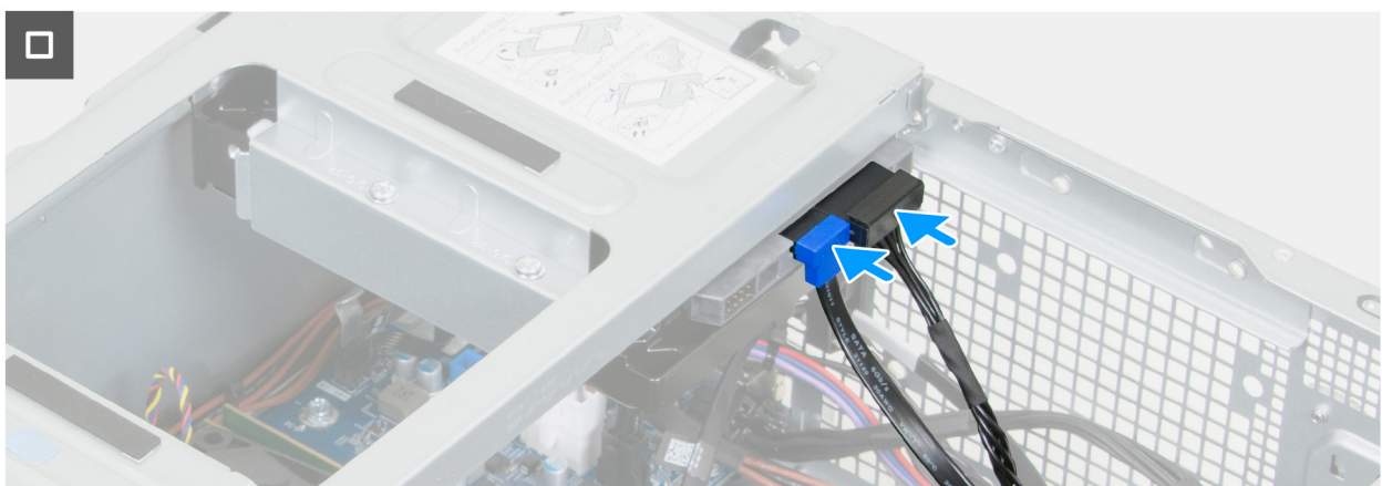
Figure 32. Installation de la baie de disques
