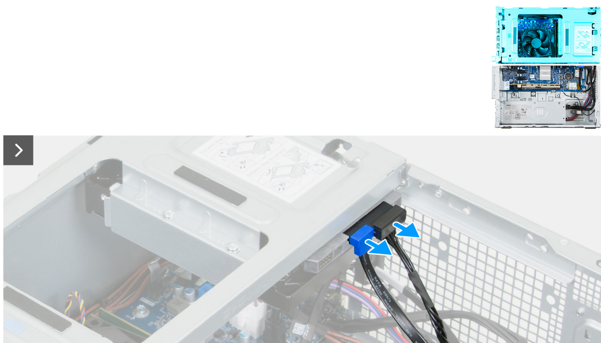
Figure 28. Retrait de la baie de disques
