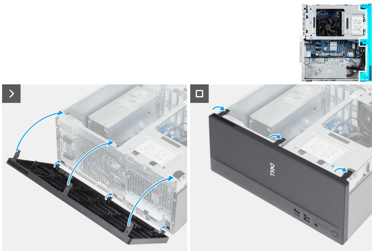
Figure 19. Installation du capot avant
