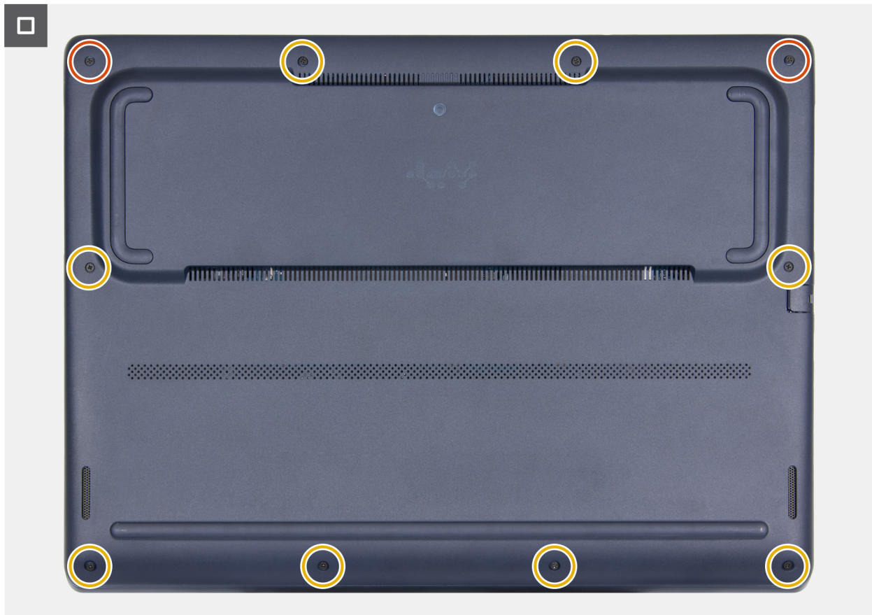
Abbildung 18. Anbringen der Bodenabdeckung
