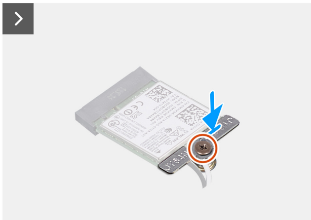
Abbildung 36. Installieren der Wireless-Karte
