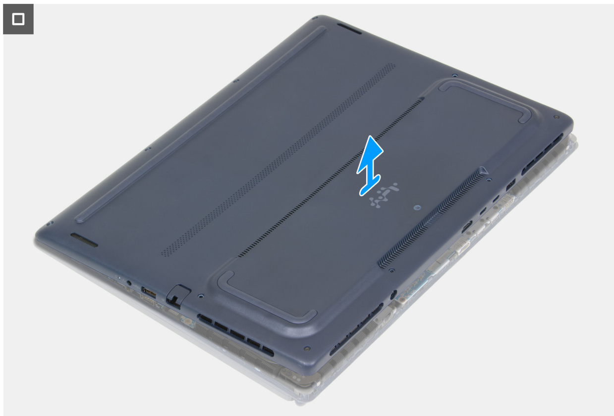
Abbildung 13. Entfernen der Bodenabdeckung
