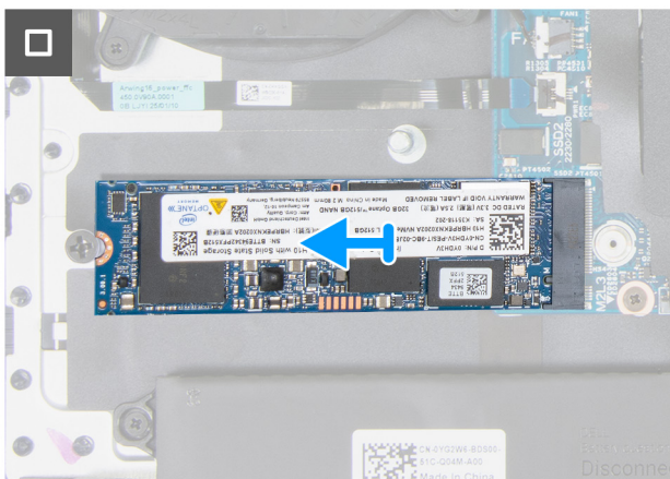
Abbildung 31. Entfernen des M.2 2280-SSD-Laufwerks aus dem Steckplatz SSD2
