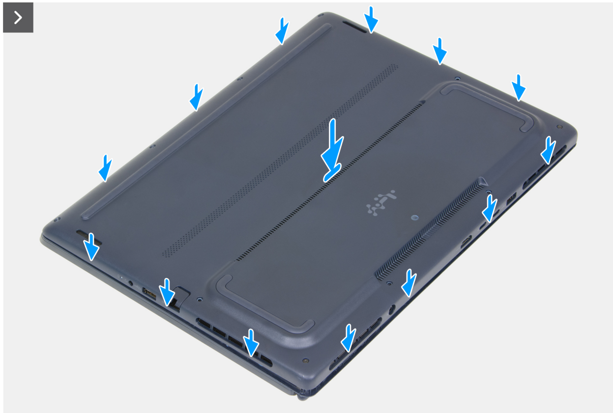
Abbildung 17. Anbringen der Bodenabdeckung
