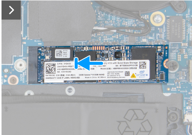
Abbildung 30. Installieren des M.2 2280-SSD-Laufwerks im Steckplatz SSD1
