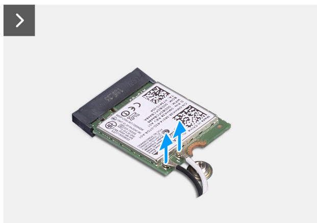
Abbildung 35. Entfernen der Wireless-Karte
