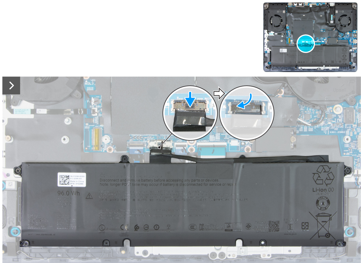
Abbildung 16. Verbinden des Akkukabels
