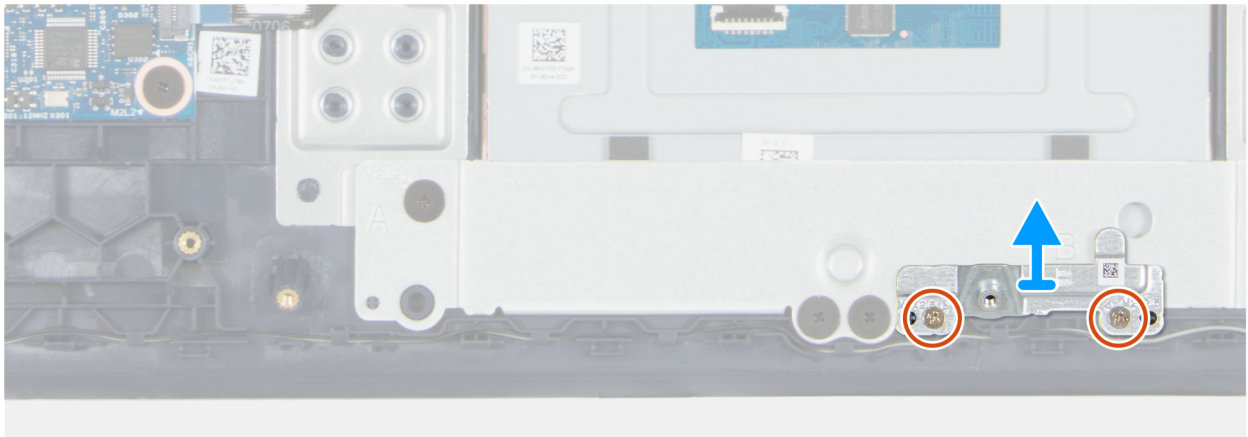
Abbildung 43. Entfernen der Akkuhalterung
