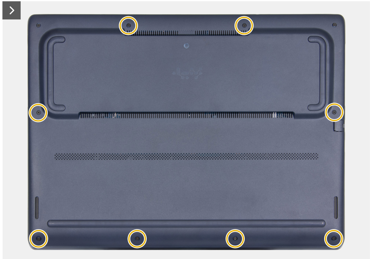
Abbildung 10. Entfernen der acht Schrauben an der Bodenabdeckung
