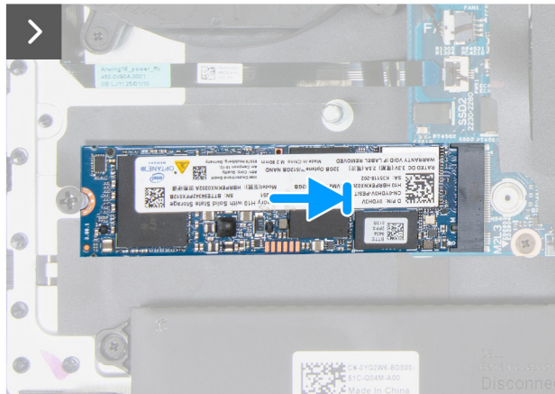
Abbildung 32. Installieren des M.2 2280-SSD-Laufwerks im Steckplatz SSD2
