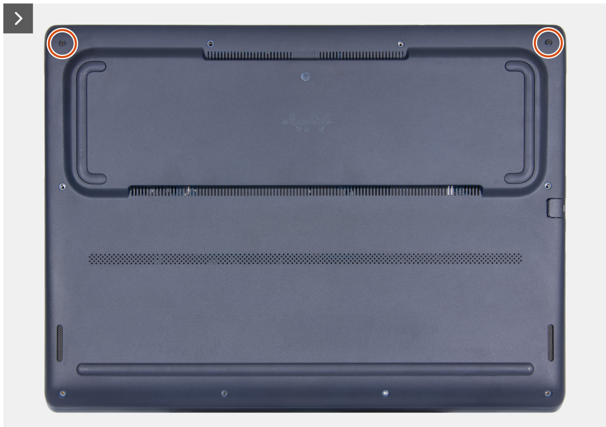
Abbildung 11. Lösen der unverlierbaren Schrauben an der Bodenabdeckung
