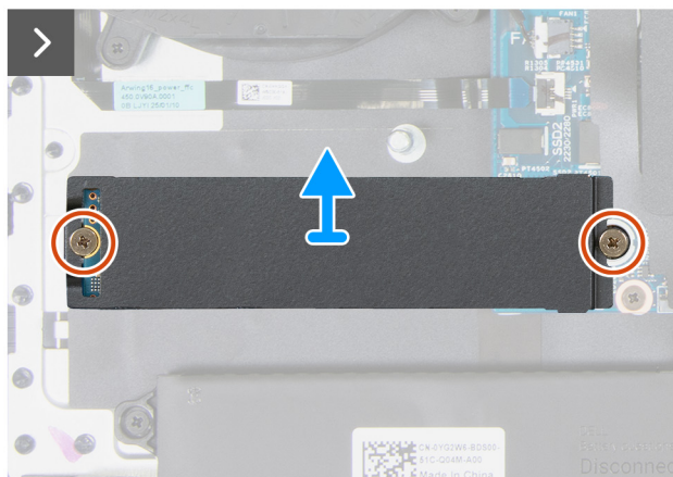
Abbildung 31. Entfernen des M.2 2280-SSD-Laufwerks aus dem Steckplatz SSD2
