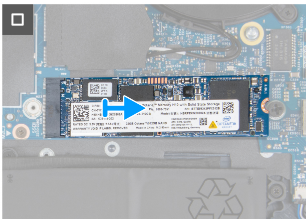
Abbildung 29. Entfernen des M.2 2280-SSD-Laufwerks aus dem Steckplatz SSD1
