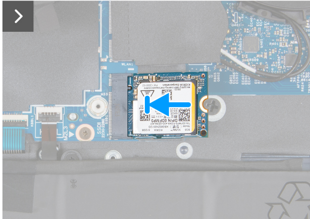
Abbildung 26. Installieren des M.2 2230-SSD im Steckplatz SSD1
