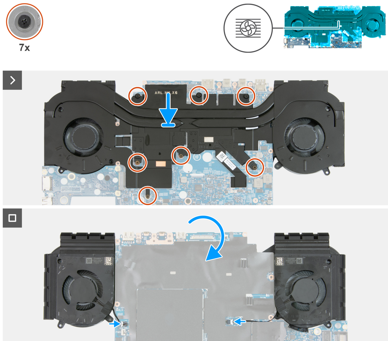
Abbildung 63. Installieren der Lüfter- und Kühlkörperbaugruppe
