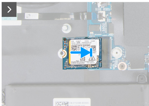
Abbildung 27. Entfernen des M.2 2230-SSD-Laufwerks aus dem Steckplatz SSD2
