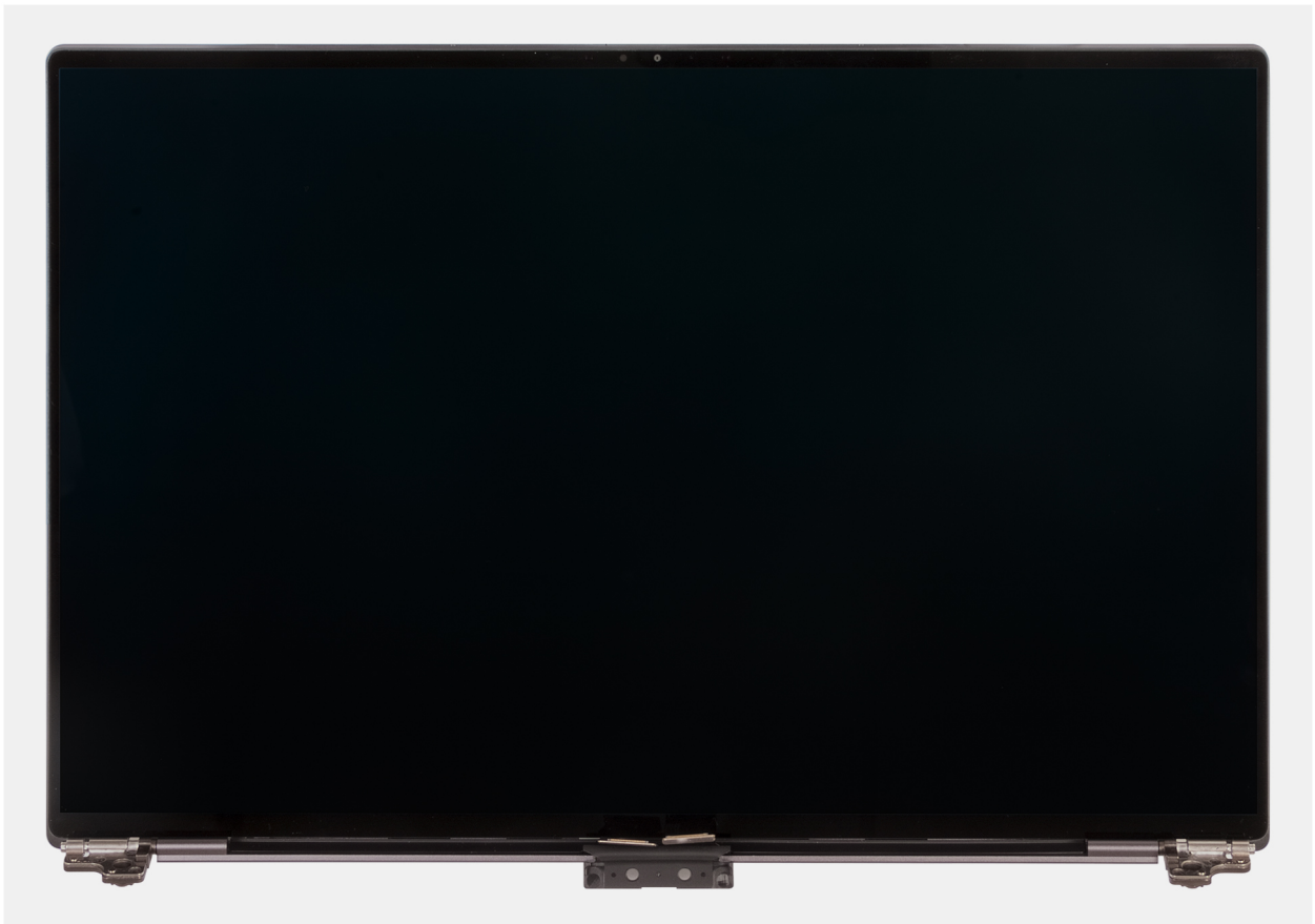
Ilustración 25. Ensamblaje de la pantalla
