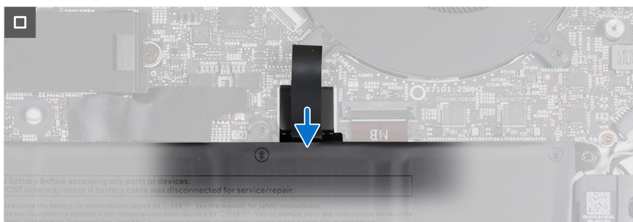
Ilustración 6. Desconexión del cable de la batería
