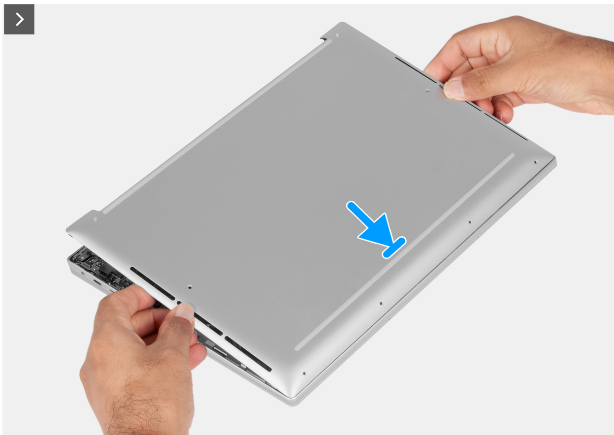
Ilustración 8. Instalación de la cubierta de la base
