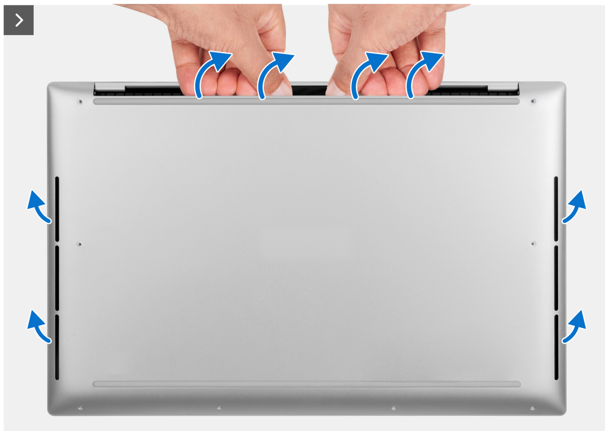
Ilustración 4. Extracción de la cubierta de la base
