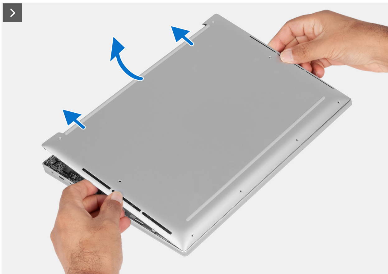
Ilustración 5. Extracción de la cubierta de la base
