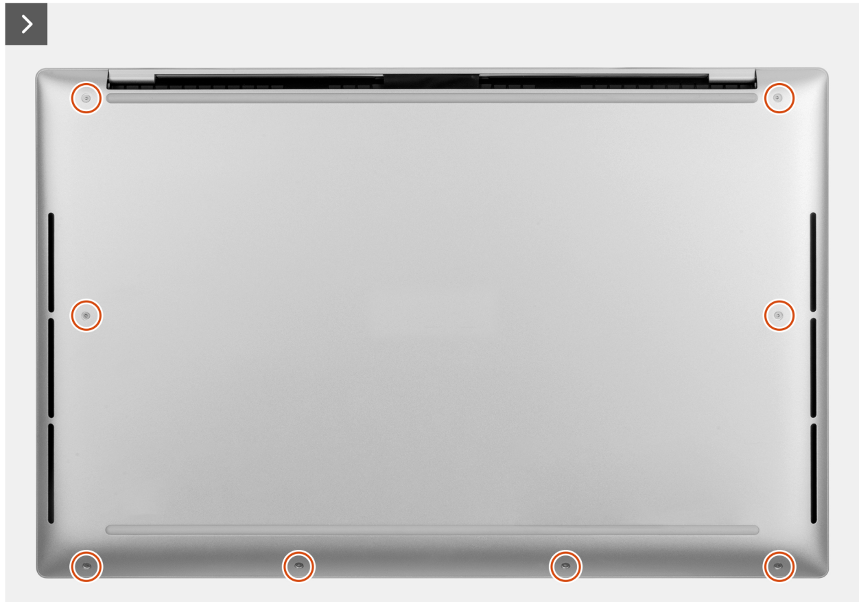
Ilustración 3. Extracción de la cubierta de la base
