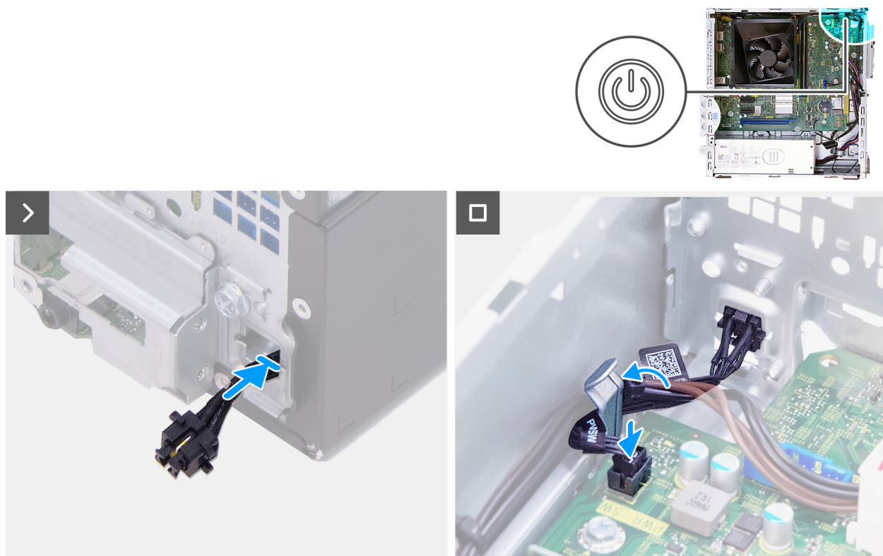
Figure 44. Installation du bouton d'alimentation
