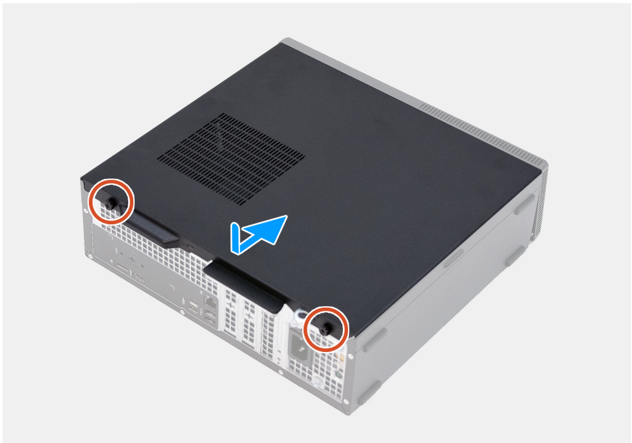
Figure 11. Installation du panneau latéral gauche
