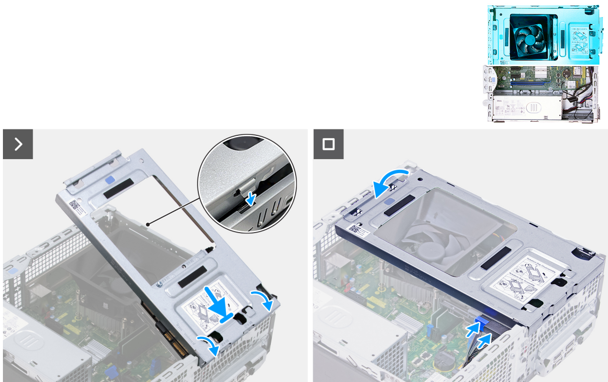
Figure 20. Installation de la baie de disques
