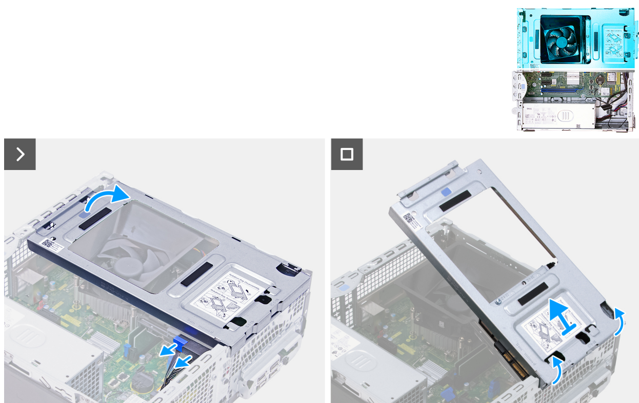
Figure 18. Retrait de la baie de disques
