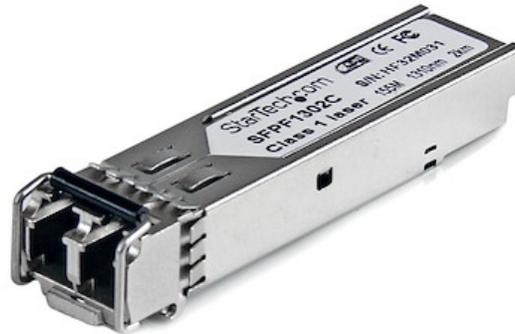
Le modèle SFPF1302C est un module de transceiver à fibre optique compatible avec Cisco GLC-FE-100FX, qui a été conçu, programmé et testé pour fonctionner avec les commutateurs et routeurs de la marque Cisco®. Il fournit une connectivité 100 Mb fiable sur câble à fibre optique pour les réseaux conformes aux spécifications 100BASE-FX, avec une distance maximale de 2 km.
