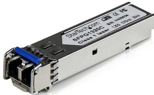
Das SFPG1320C ist ein Cisco GLC-LH-SMD-kompatibles Glasfaser-Transceiver-Modul, das speziell für die Zusammenarbeit mit Cisco®-Switches und -Router entwickelt, programmiert und getestet wurde. Es liefert zuverlässige 1-GbE-Konnektivität über Glasfaserkabel für 1000BASE-LH-konforme Netzwerke mit einer maximalen Entfernung von bis zu 20 km.
