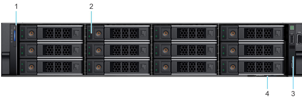
Ilustración 18. Vista frontal de un sistema con 12 unidades SAS/SATA de 3,5 pulgadas
