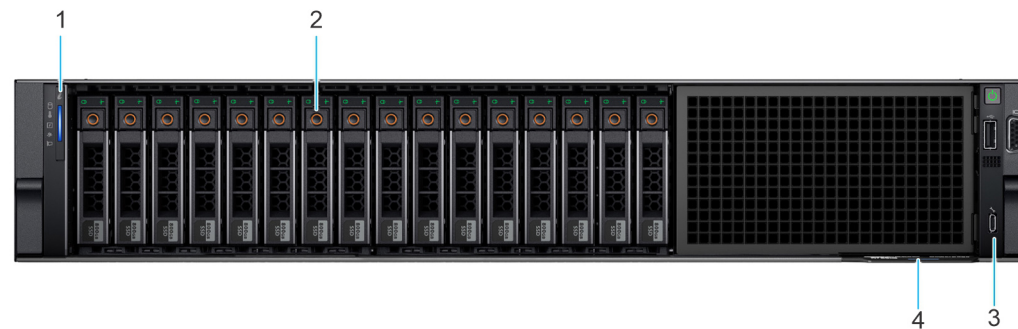
Ilustración 19. Vista frontal de un sistema con 16 unidades SAS/SATA de 2,5 pulgadas
