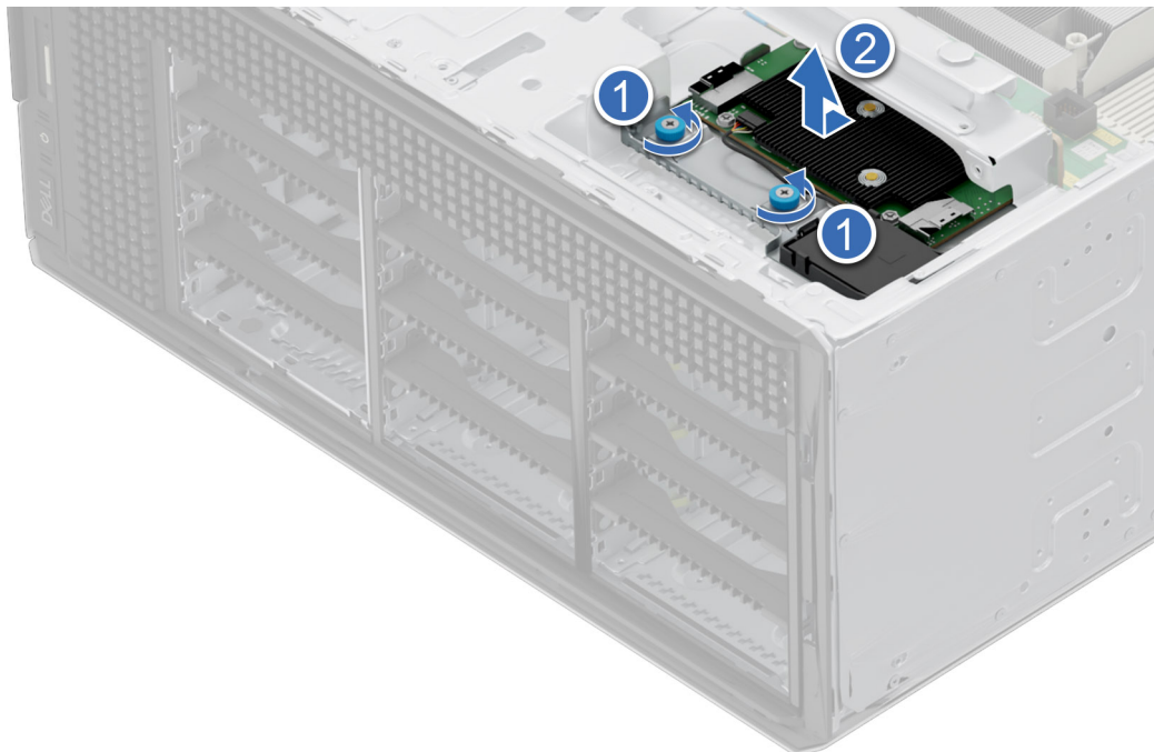
Ilustración 96. Extracción del módulo de PERC frontal del backplane de unidades de 3,5 pulgadas
