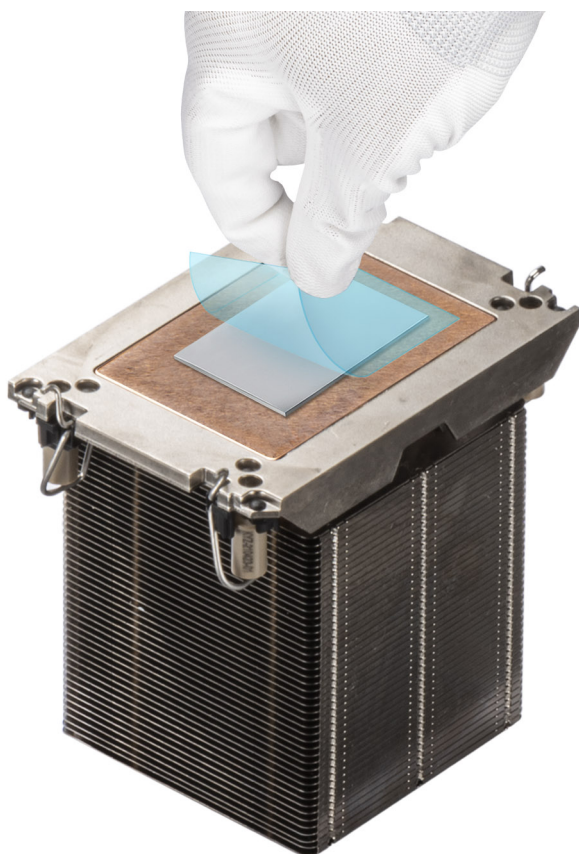
Ilustración 168. Extracción de la película de protección del material de interfaz térmica (TIM)
