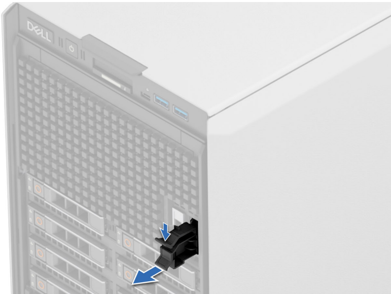
Ilustración 198. Extracción del módulo de BOSS-N1 de relleno
