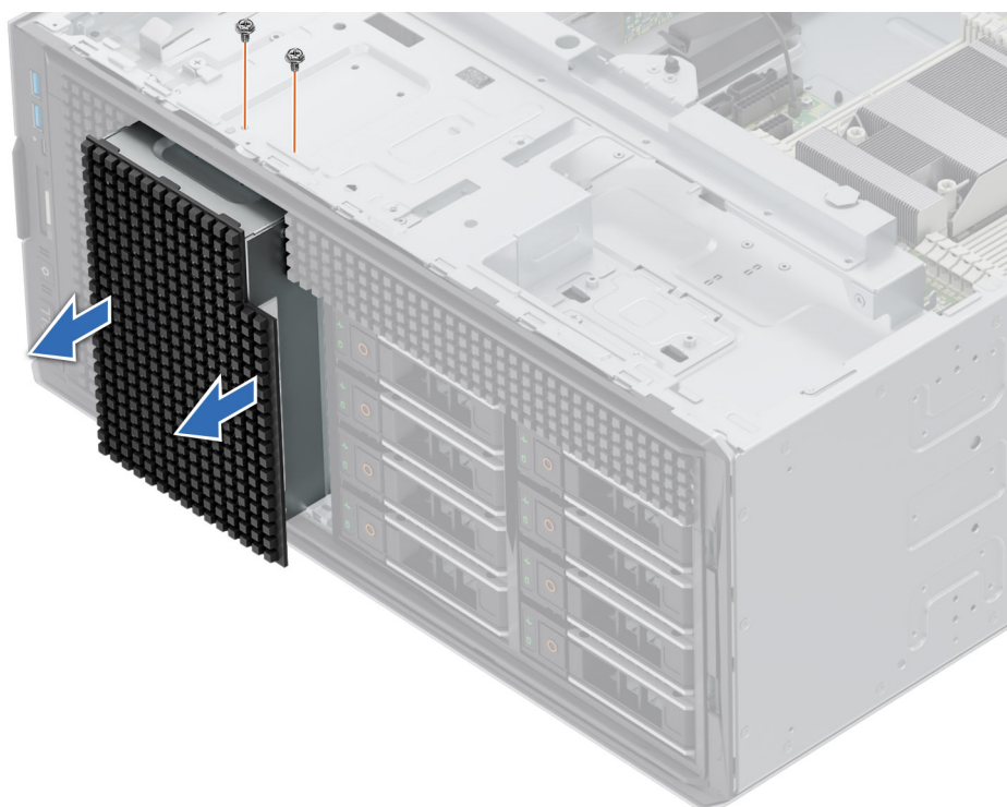
Ilustración 115. Extracción del panel de relleno de la bahía de unidad NVMe
