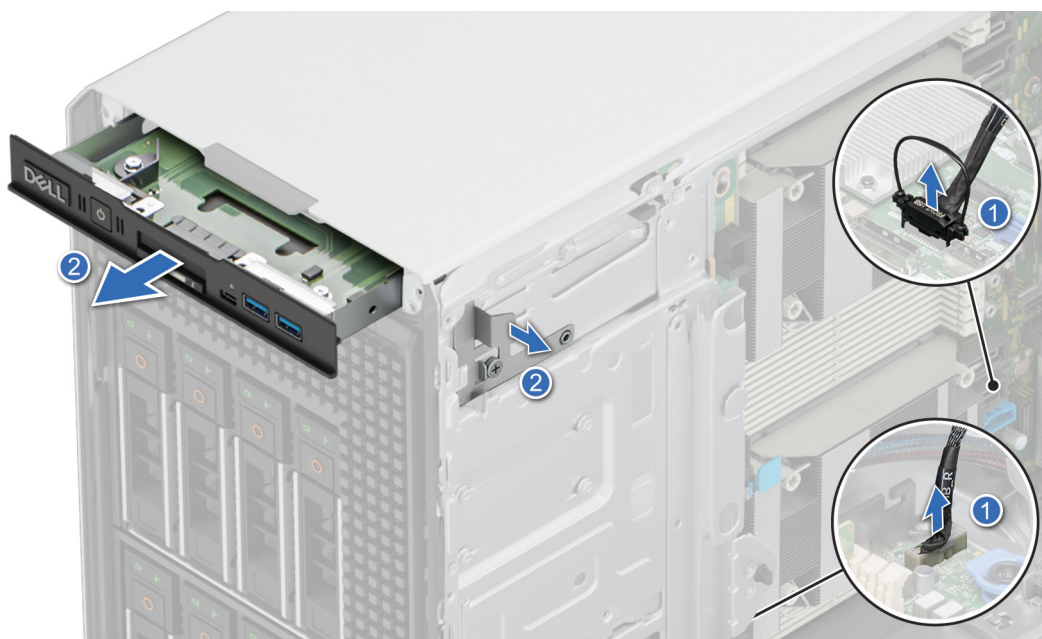
Ilustración 133. Extracción del módulo de I/O frontal
