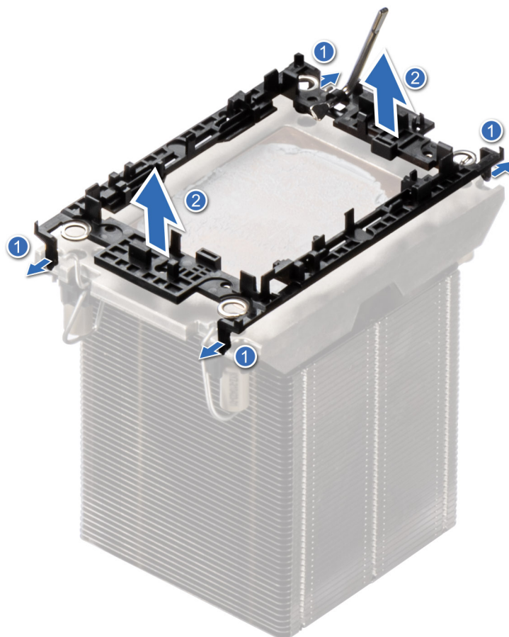
Ilustración 164. Extracción del gancho de retención
