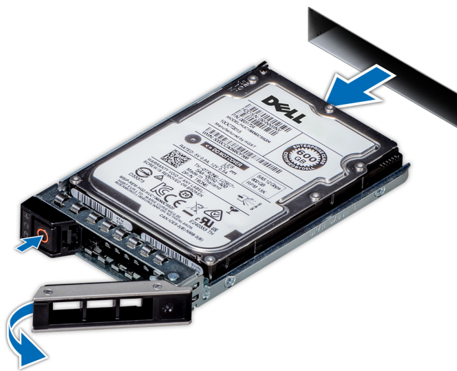
Ilustración 102. Extracción de un portaunidades
