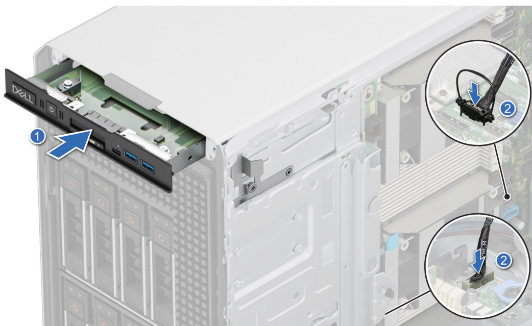
Ilustración 134. Instalación del módulo de I/O frontal
