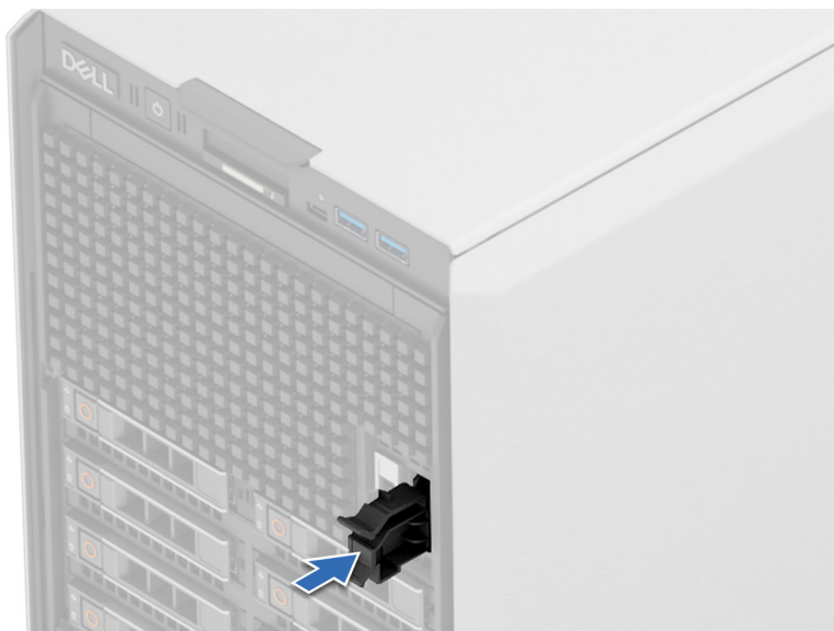
Ilustración 199. Instalación del módulo de BOSS-N1 de relleno
