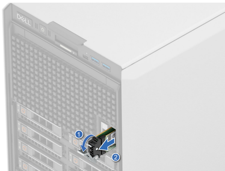
Ilustración 142. Extracción del portaunidades de tarjeta BOSS-N1
