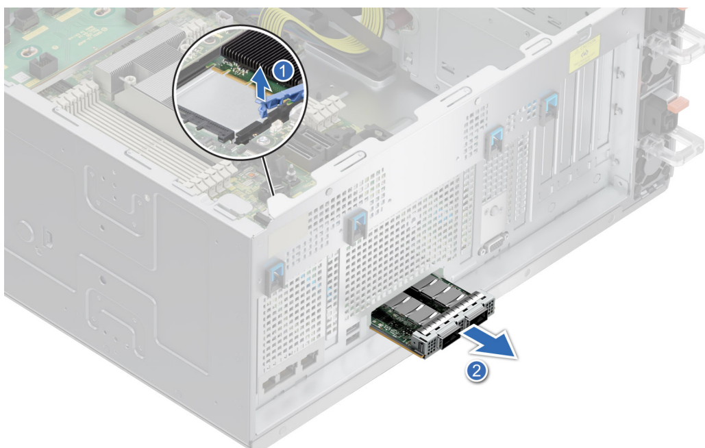
Ilustración 173. Extracción de la tarjeta OCP
