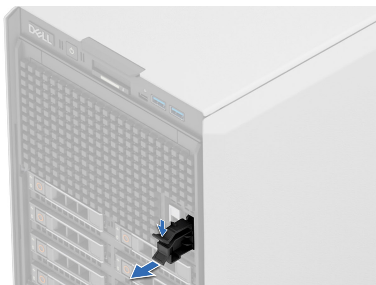
Ilustración 145. Extracción del portaunidades de tarjeta BOSS-N1 de relleno
