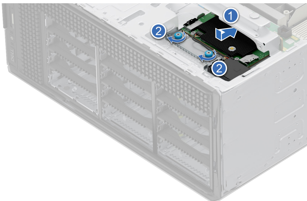
Ilustración 98. Instalación del módulo de PERC frontal en el backplane de unidades de 3,5 pulgadas
