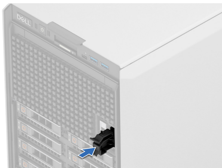
Ilustración 144. Instalación del portaunidades de tarjeta BOSS-N1 de relleno
