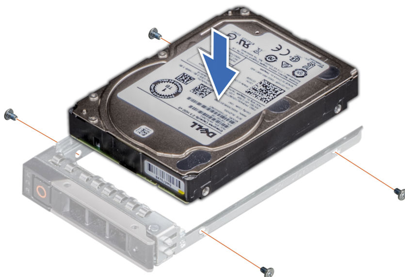
Ilustración 104. Instalación de una unidad en el portaunidades
