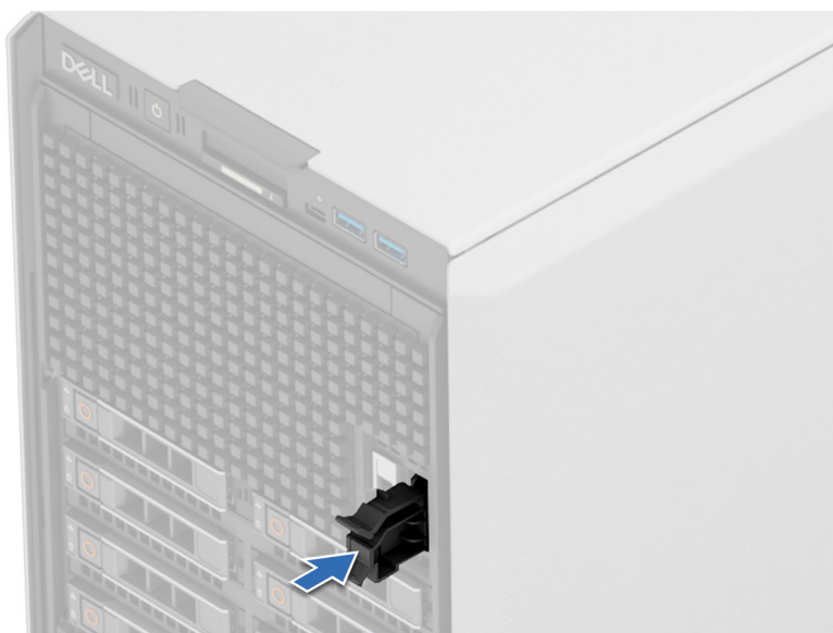
Figure 144. Installation du cache du support de carte BOSS-N1
