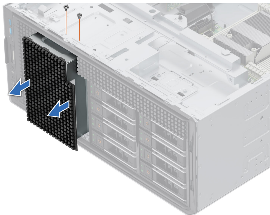
Figure 115. Retrait du cache de baie de disques NVMe
