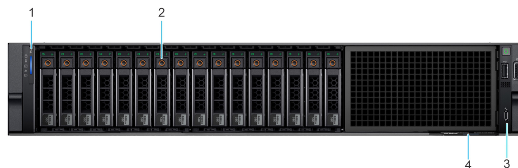
Figure 19. Vue avant d'un système à 16 disques SAS/SATA de 2,5 pouces
