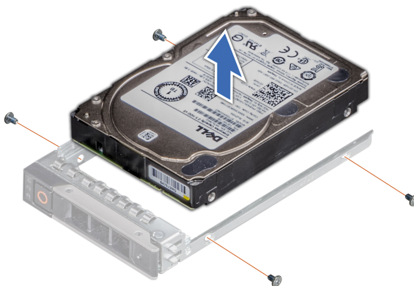
Figure 67. Retrait d'un disque dur installé de son support
