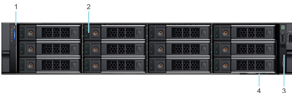
Figure 18. Vue avant d'un système à 12 disques SAS/SATA de 3,5 pouces
