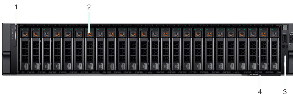
Figure 17. Vue avant d'un système à 16 disques SAS/SATA de 2,5 pouces + 8 disques NVMe de 2,5 pouces
