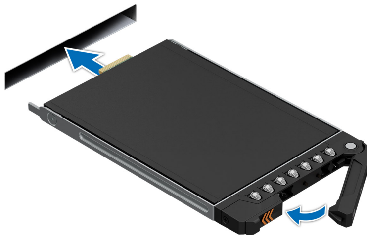
Ilustración 46. Instalación de una unidad E3.S
