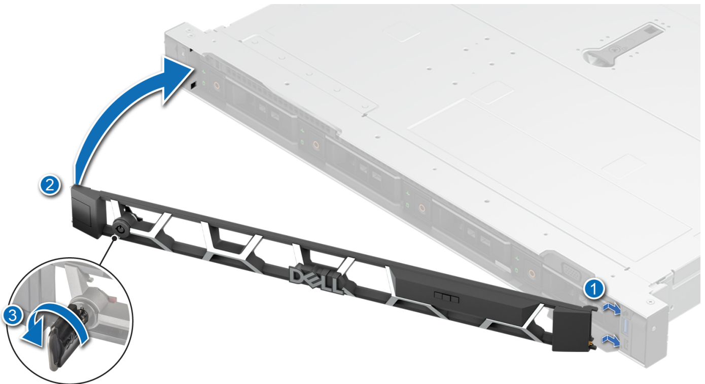
Ilustración 30. Instalación del bisel frontal
