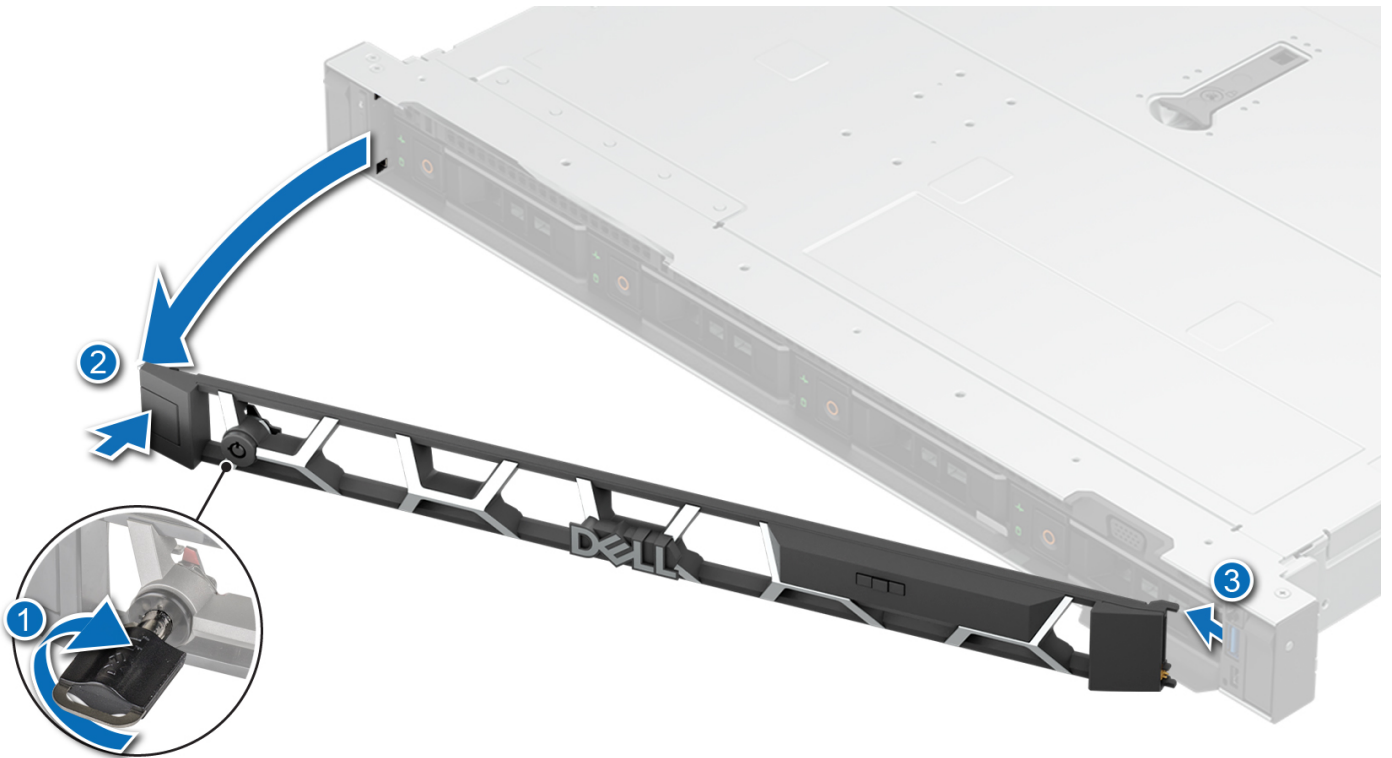
Ilustración 29. Extracción del bisel frontal
