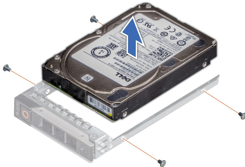
Ilustración 47. Extracción de una unidad del portaunidades
