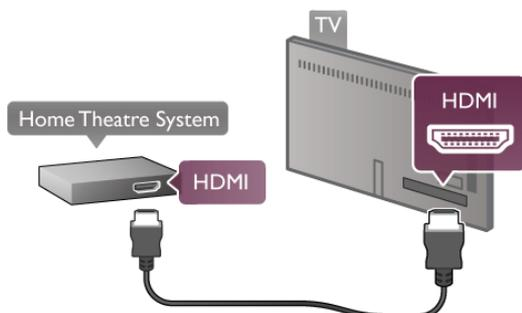
Si el sistema de cine en casa no dispone de conexión HDMI ARC, añada un cable óptico para enviar el sonido de la imagen del televisor al sistema de cine en casa.
