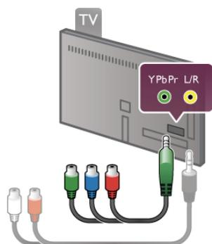
Utilice el cable adaptador YPbPr suministrado para conectar el dispositivo. Empareje los colores de los conectores YPbPr (verde, azul y rojo) con las tomas de los cables cuando realice la conexión.
