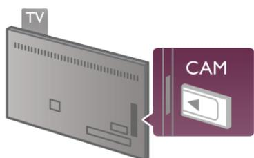
Utilice la ranura de interfaz común del lateral izquierdo del televisor para insertar la tarjeta CAM\*. Introduzca suavemente el CAM hasta el fondo y déjela en la ranura permanentemente. El CAM puede tardar unos minutos en activarse. Si quita el CAM se desactivará el servicio de emisión en el televisor.
