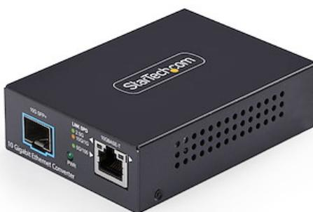
Questo convertitore multimediale 10G compatto consente una conversione senza interruzioni da rame a fibra per aggiornamenti di rete o estensioni a lunga distanza. Dotato di uno slot SFP+ aperto, converte da 100M a 10GBASE-T RJ-45 a fibra 10G e supporta ricetrasmettitori multimodali e monomodali (10GBASE-SR/LR) per un'implementazione flessibile in ambienti aziendali e di telecomunicazione.
