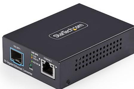
Ce convertisseur de médias 10G compact assure une conversion cuivre-vers-fibre fluide pour les mises à niveau réseau ou l'extension longue distance. Équipé d'un logement SFP+ ouvert, il convertit le 100M à 10GBASE-T (RJ-45) vers de la fibre 10G et prend en charge les émetteurs-récepteurs multimode et monomode (10GBASE-SR/LR) pour des déploiements flexibles dans les environnements d'entreprise et de télécommunications.
