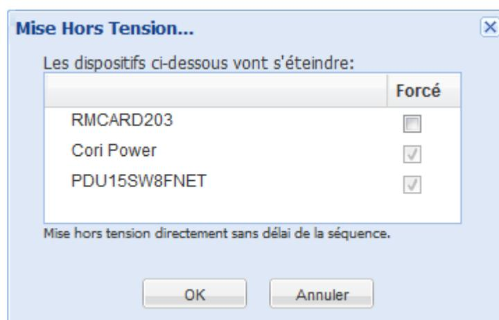
Une fenêtre de confirmation de l'opération de mise hors tension brute
