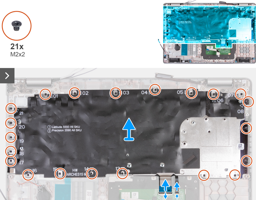
Ilustración 65. Extracción del teclado
