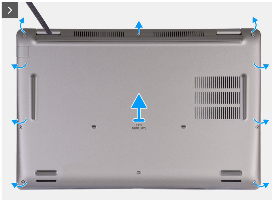
Ilustración 14. Extracción de la cubierta de la base
