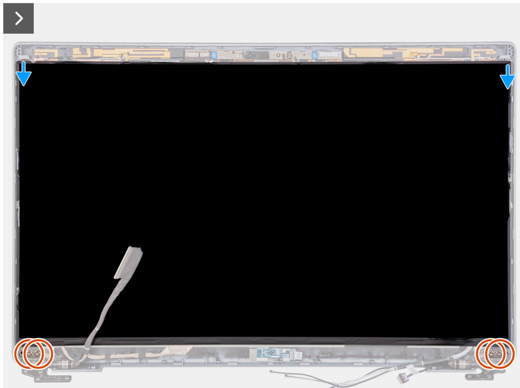
Ilustración 76. Extracción del panel de pantalla
