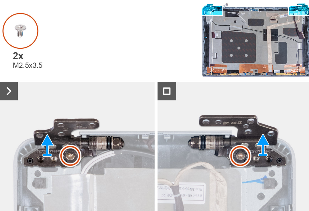
Ilustración 86. Extracción de las bisagras de la pantalla
