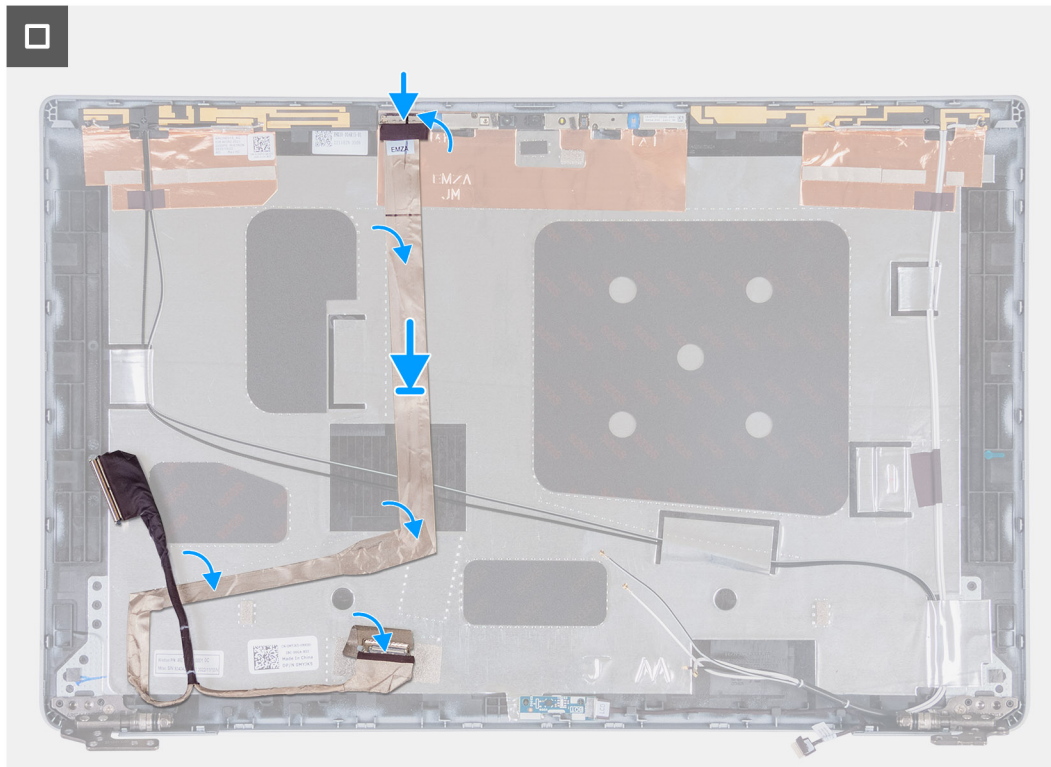
Ilustración 91. Instalación del cable de pantalla
