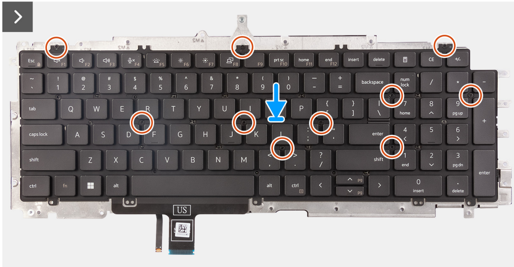
Ilustración 67. Instalación del teclado
