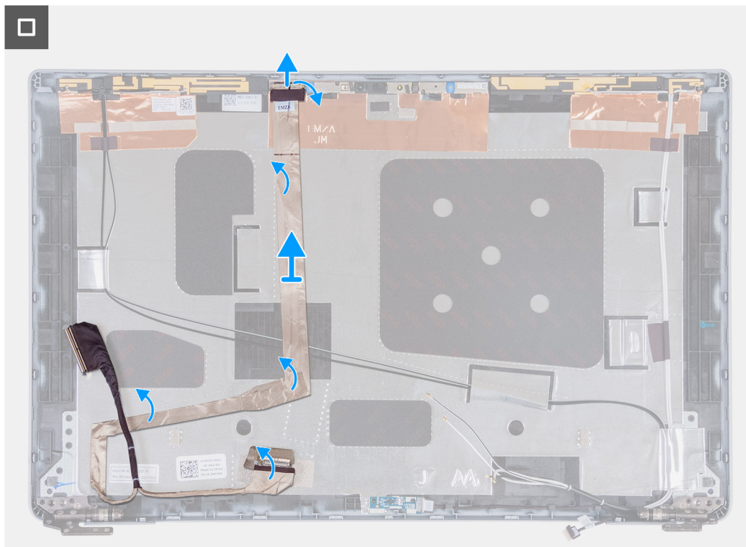
Ilustración 90. Extracción del cable de pantalla
