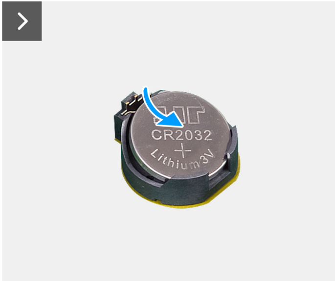
Ilustración 41. Instalación de la batería de tipo botón
