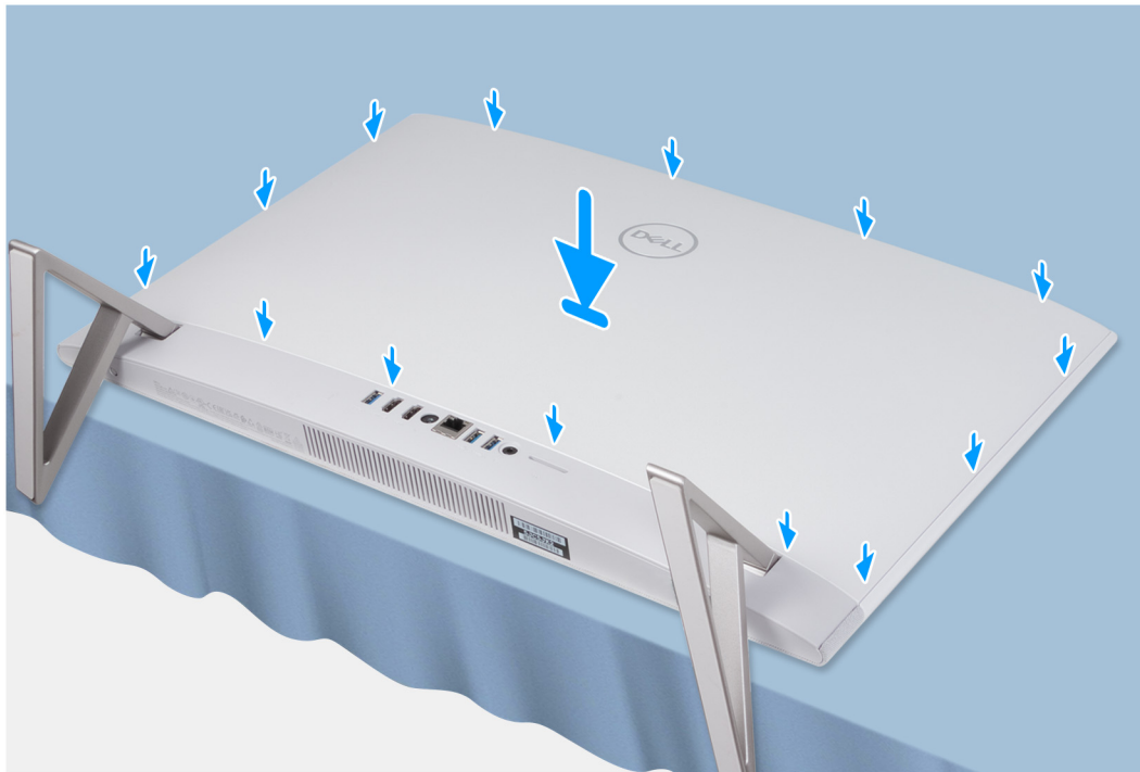
Ilustración 21. Instalación de la cubierta posterior
