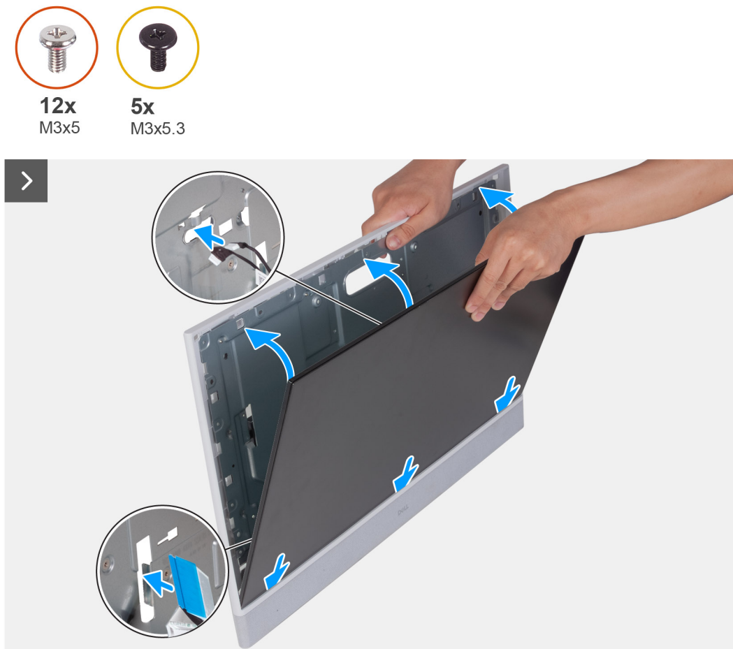
Ilustración 62. Instalación del panel de pantalla
