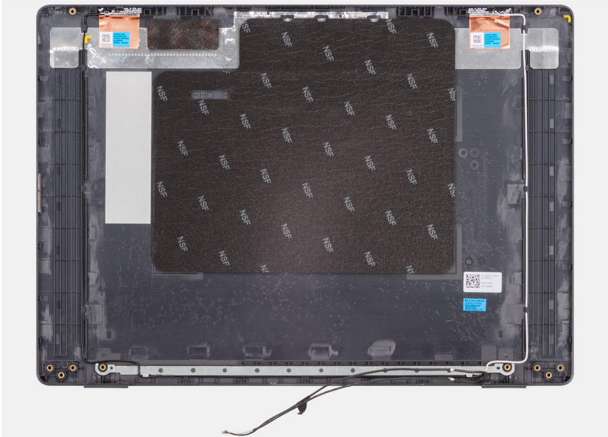
Ilustración 86. Extracción del ensamblaje de la cubierta posterior de la pantalla
