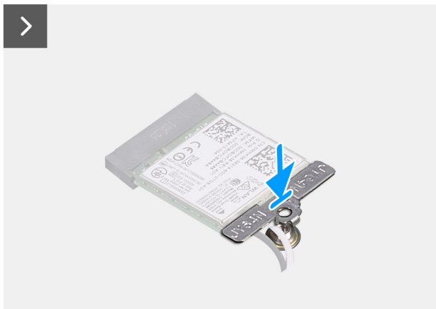
Ilustración 26. Instalación de la tarjeta inalámbrica
