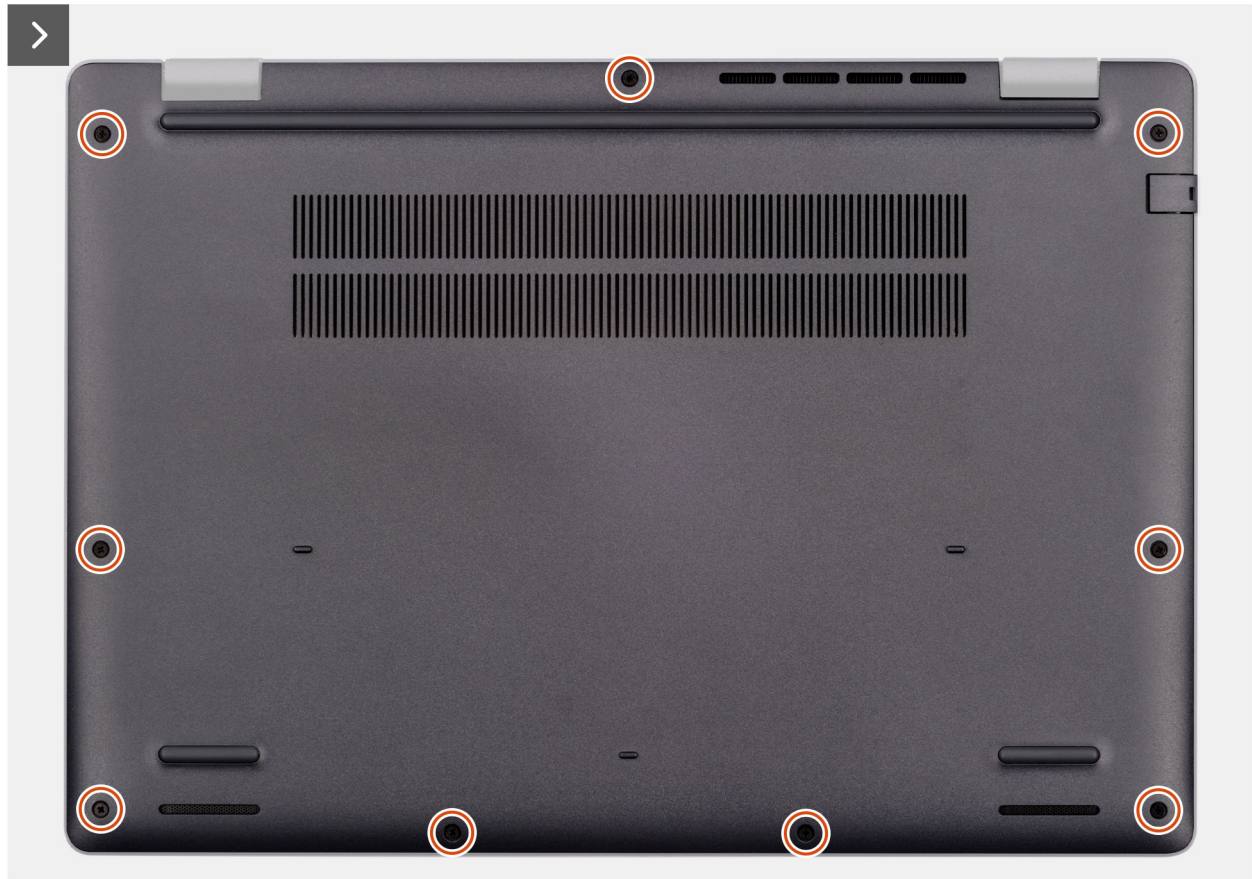
Ilustración 11. Extracción de la cubierta de la base
