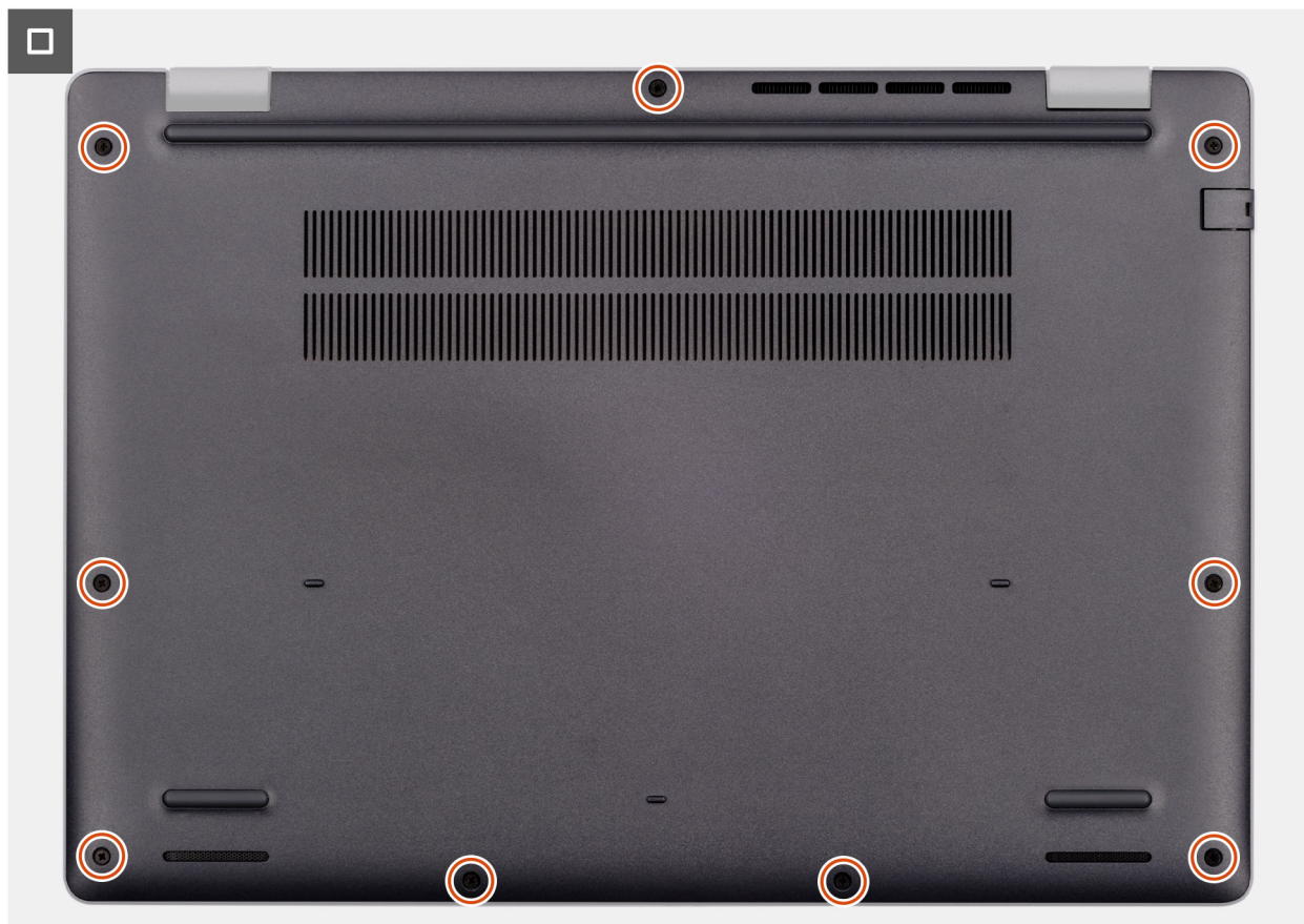
Ilustración 16. Instalación de la cubierta de la base
