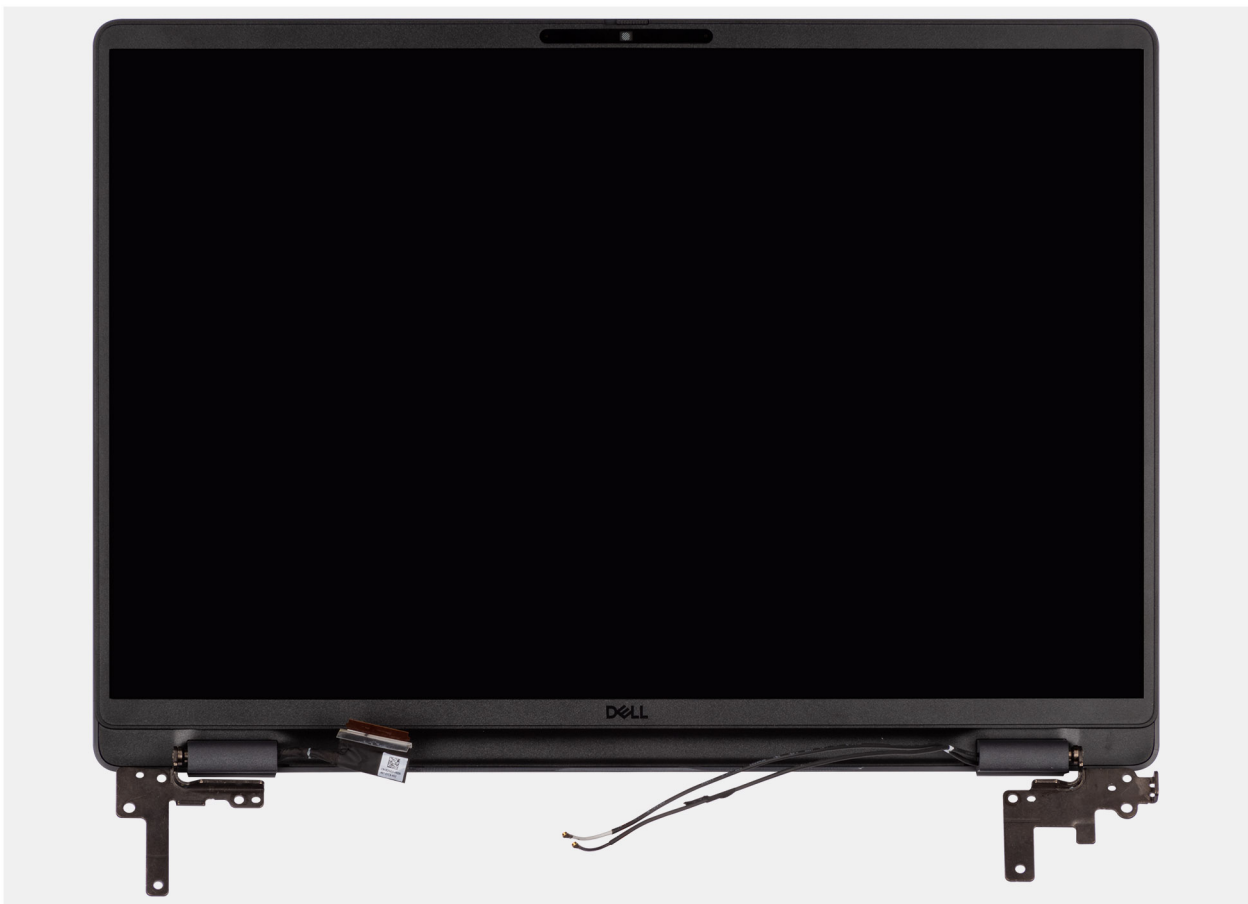
Ilustración 64. Extracción del ensamblaje de la pantalla
