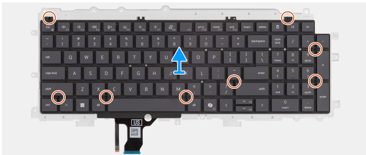
Ilustración 56. Extracción de la placa de soporte del teclado
