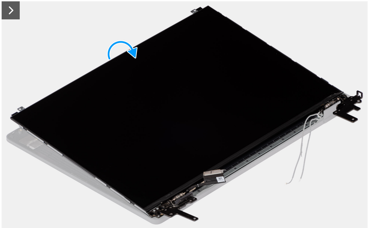
Ilustración 75. Extracción del ensamblaje del panel de pantalla
