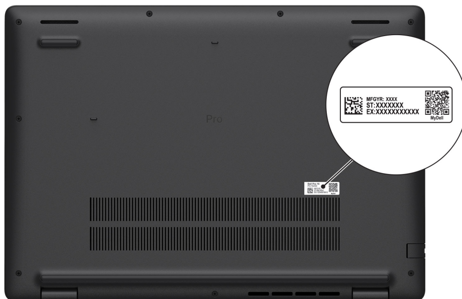
Ilustración 6. Ubicación de la etiqueta de servicio o del código de servicio rápido
