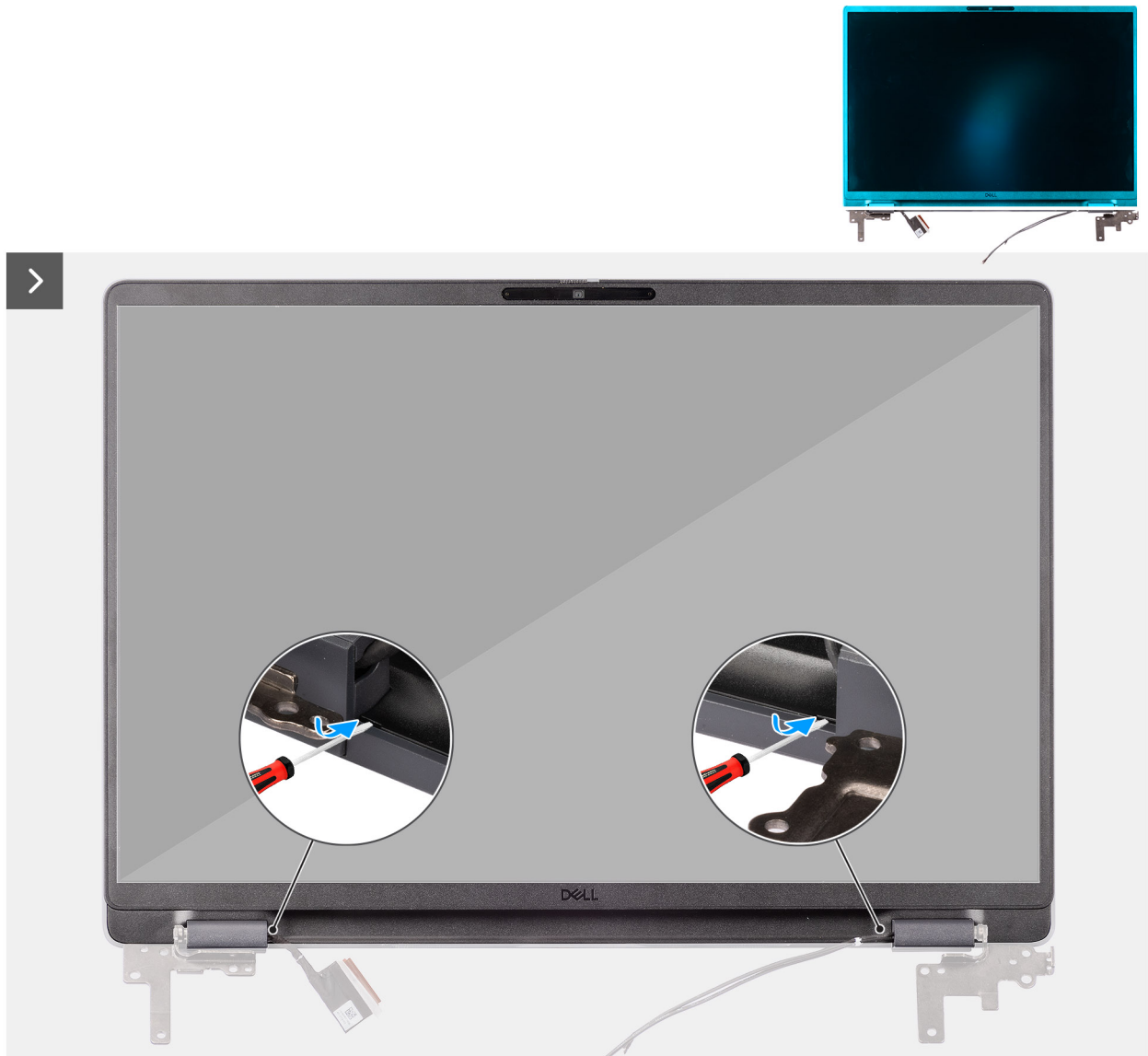
Ilustración 67. Extracción del embellecedor de la pantalla
