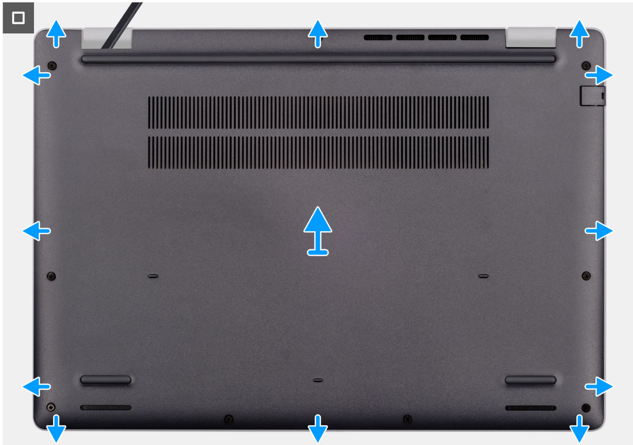
Ilustración 12. Extracción de la cubierta de la base
