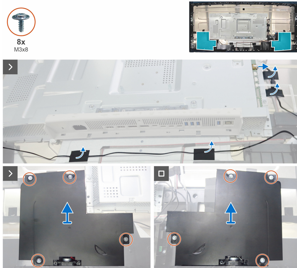
Figura 13. Desmontaje de los altavoces
