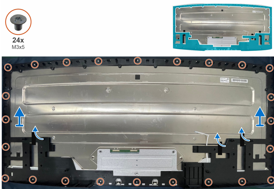
Figura 33. Desmontaje del marco central
