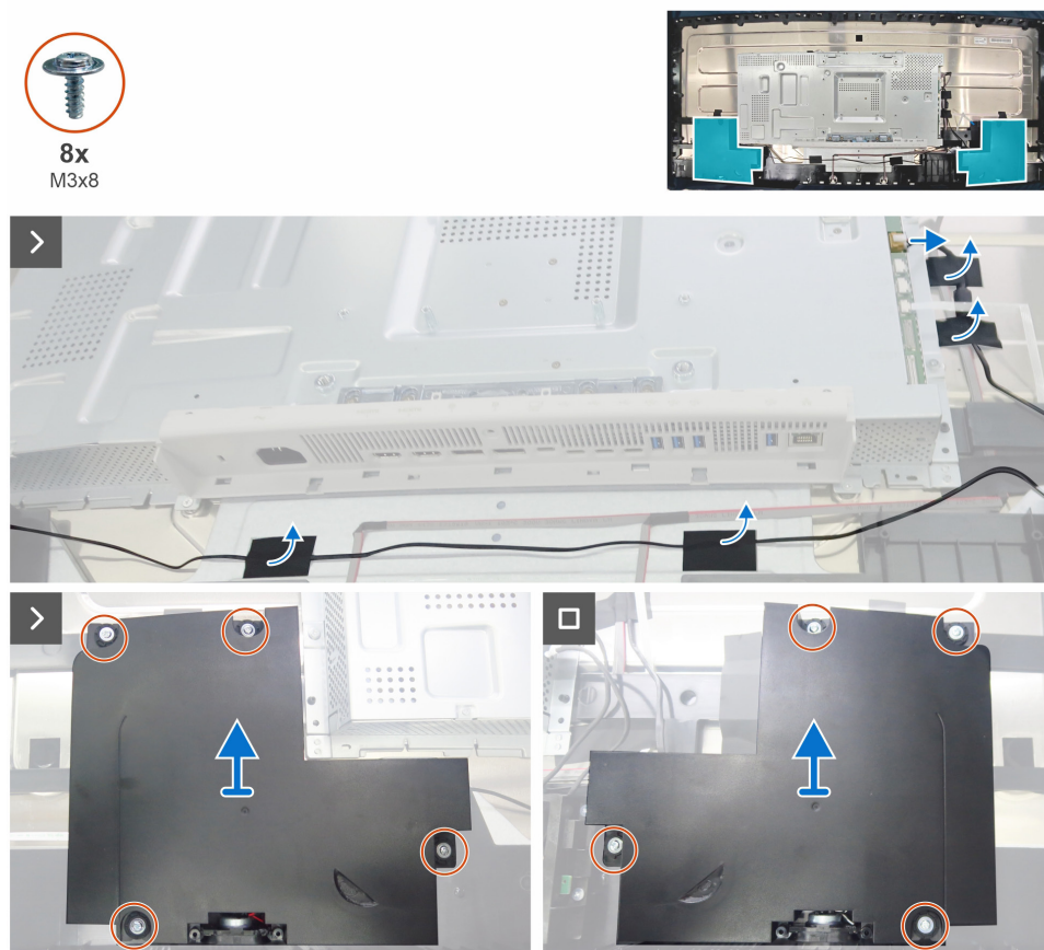
Figura 27. Desmontaje de los altavoces
