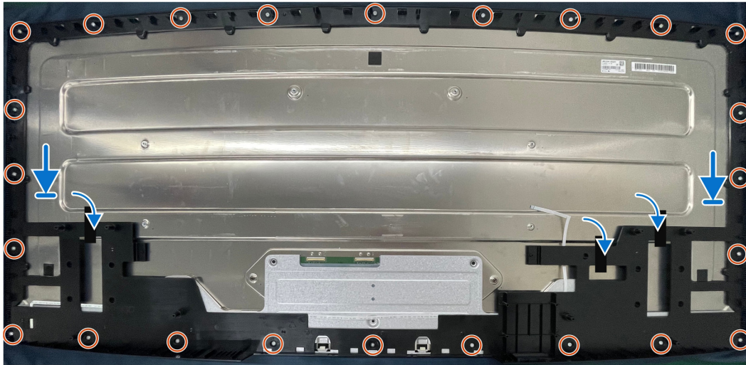
Figura 34. Instalación del marco central
