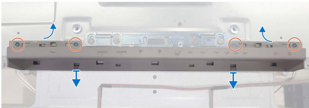
Figura 29. Desmontaje de la tapa de E/S
