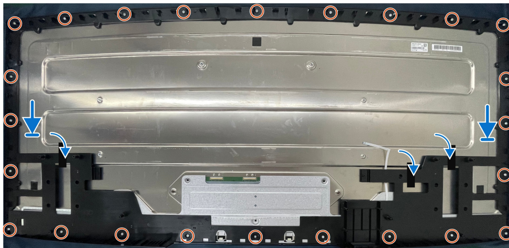
Rysunek 34. Instalowanie ramy wewnętrznej
