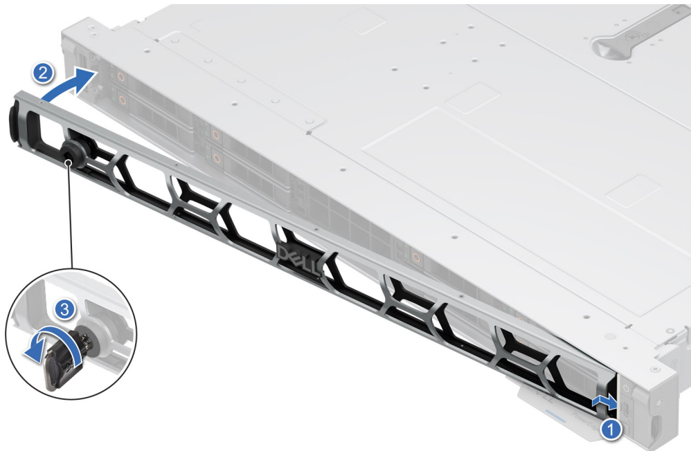
Abbildung 37. Installieren der Frontverkleidung
