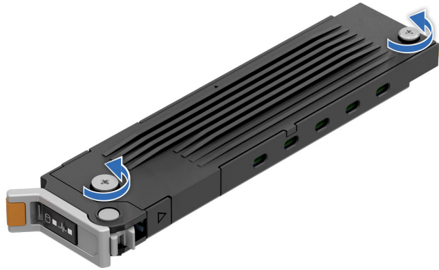
Abbildung 167. Lösen der unverlierbaren Schrauben der oberen Abdeckung
