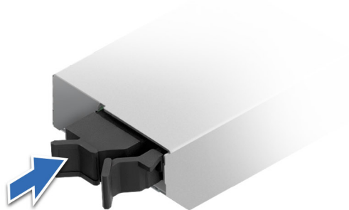
Abbildung 187. Installieren des Platzhalters für den BOSS-N1-DC-MHS-Kartenträger
