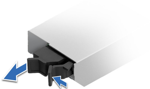
Abbildung 186. Entfernen des Platzhalters für den BOSS-N1-DC-MHS-Kartenträger
