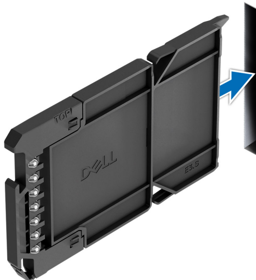
Abbildung 47. Einsetzen eines Platzhalters für ein EDSFF E3.S-Laufwerk
