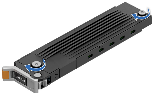
Abbildung 172. Festziehen der unverlierbaren Schrauben der oberen Abdeckung
