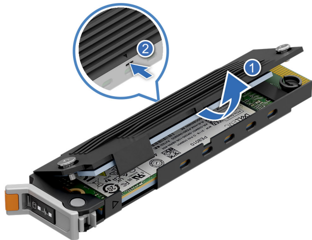
Abbildung 168. Entfernen der oberen Abdeckung
