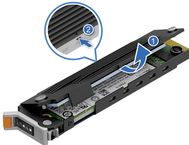
Abbildung 188. Entfernen der oberen Abdeckung
