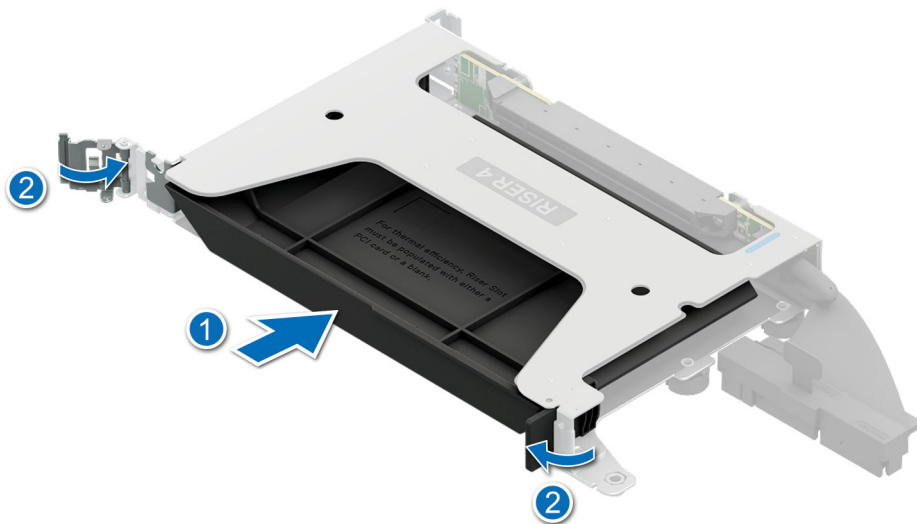
Abbildung 168. Einbauen des PCIe-Platzhalters
