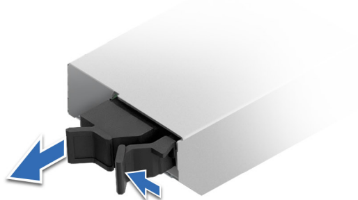
Abbildung 218. Entfernen des Platzhalters für den BOSS-N1-DC-MHS-Kartenträger
