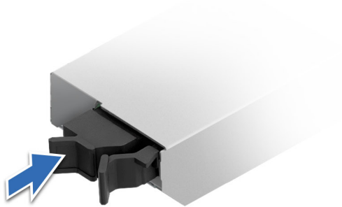
Abbildung 219. Installieren des Platzhalters für den BOSS-N1-DC-MHS-Kartenträger
