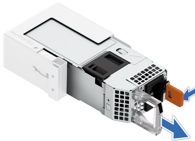
Abbildung 255. Entfernen eines Netzteils
