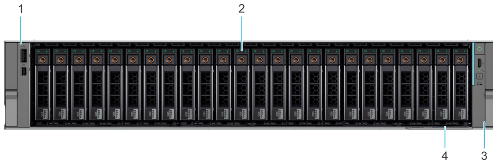
Abbildung 6. Vorderansicht eines Systems mit 24 x 2,5-Zoll-Laufwerksystemen
