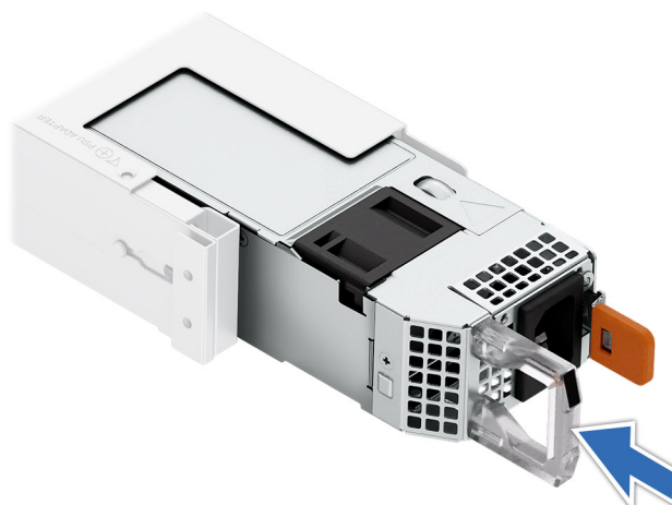
Abbildung 256. Installieren eines Netzteils
