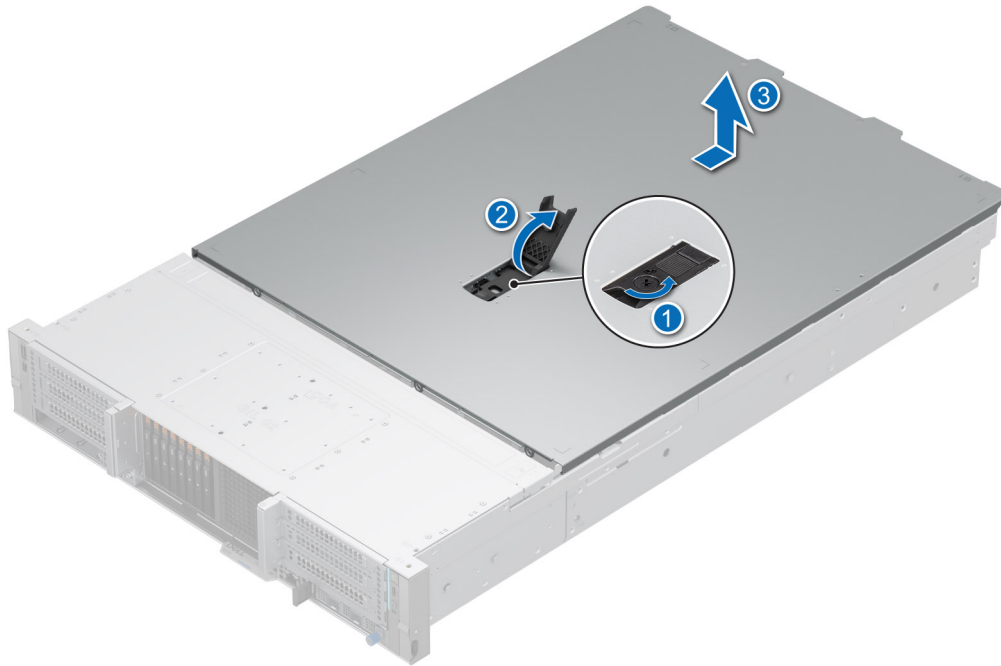
Figure 34. Retrait du capot du système
