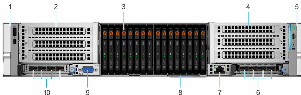
Figure 3. Vue avant du système à 16 disques NVMe EDSFF E3.S (allée froide)
