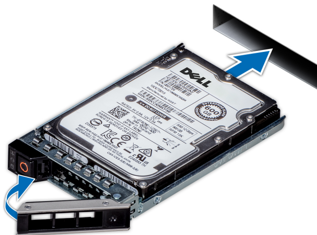
Figure 65. Installation d'un support de disque de 3,5 pouces
