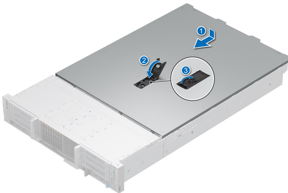
Figure 35. Installation du capot du système
