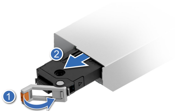
Ilustración 166. Extracción del portaunidades de tarjeta BOSS-N1
