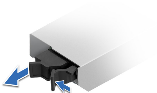
Ilustración 186. Extracción del portaunidades de tarjeta BOSS-N1 DC-MHS de relleno
