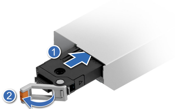
Ilustración 173. Instalación del portaunidades de tarjeta BOSS-N1
