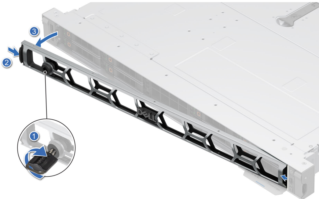
Ilustración 36. Extracción del bisel frontal
