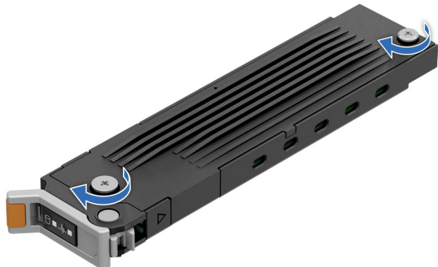
Ilustración 172. Cómo ajustar los tornillos cautivos de la cubierta superior
