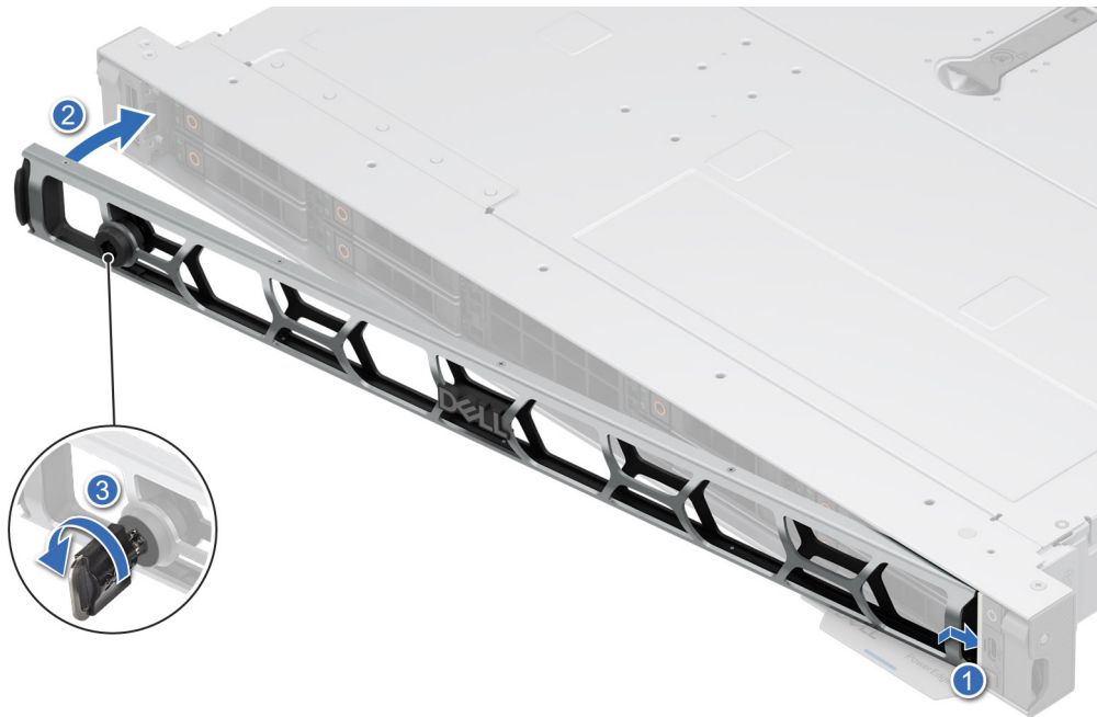
Ilustración 37. Instalación del bisel frontal
