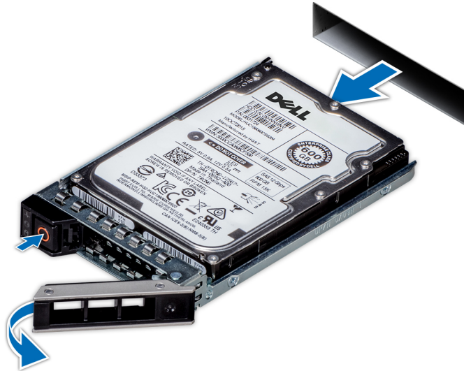
Ilustración 60. Extracción de un portaunidades de disco duro de 3,5 pulgadas
