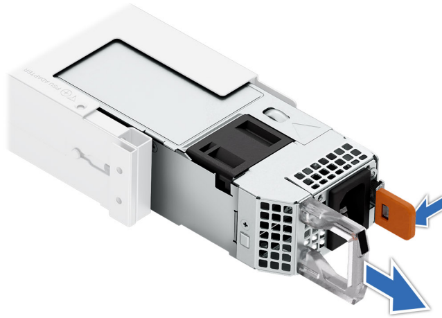
Ilustración 225. Extracción de una fuente de alimentación
