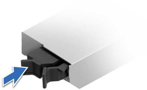
Ilustración 187. Instalación del portaunidades de tarjeta BOSS-N1 DC-MHS de relleno
