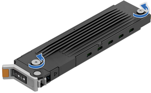
Ilustración 167. Cómo aflojar los tornillos cautivos de la cubierta superior
