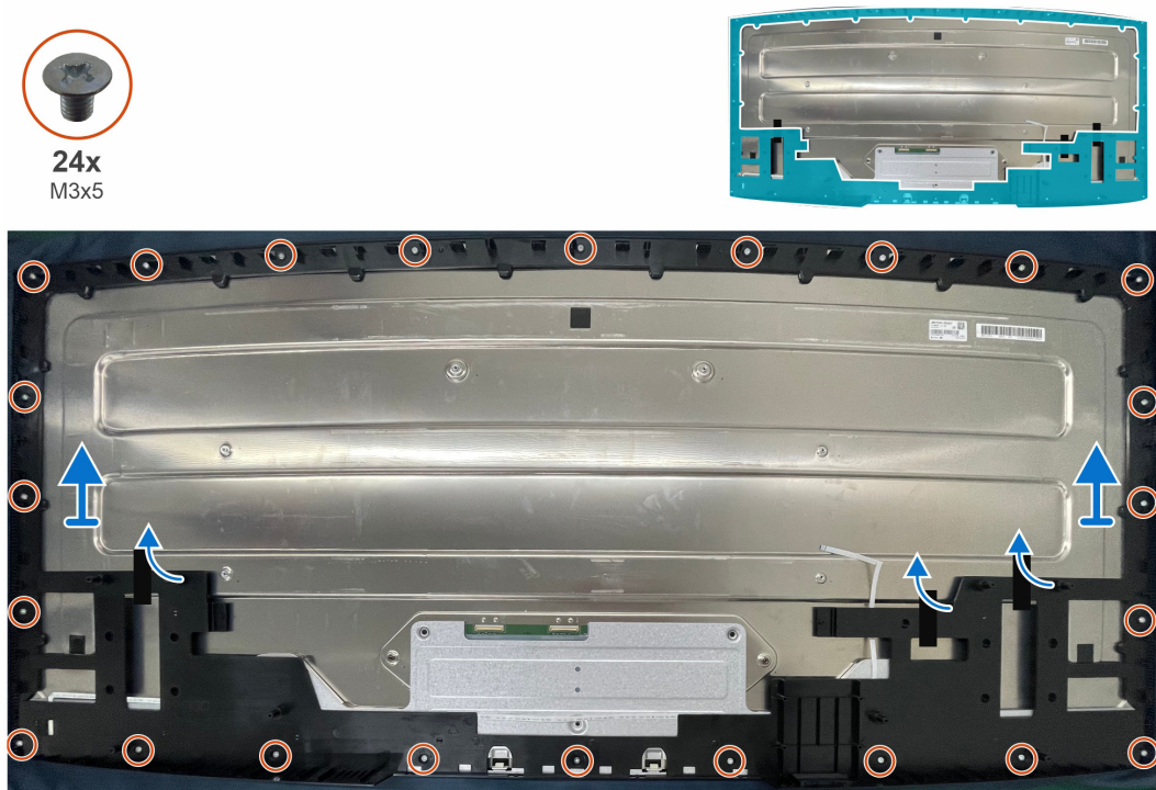
Figure 19. Retrait du cadre intermédiaire
