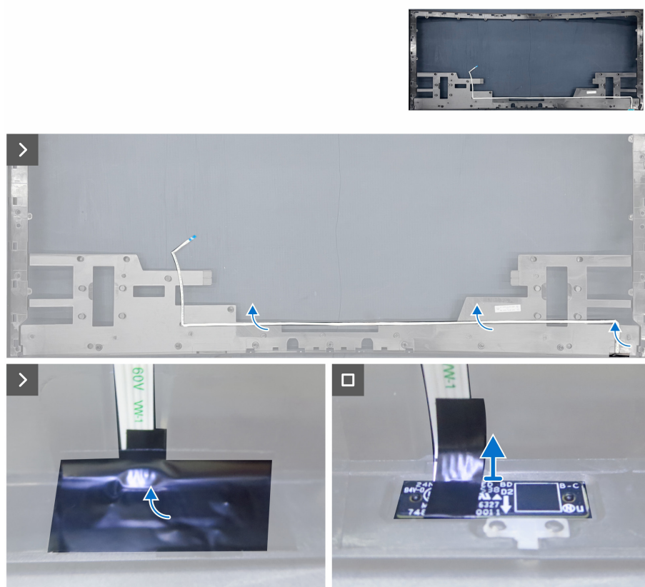
Figure 21. Retrait du câble LED
