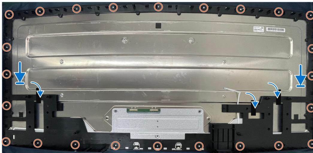
Figure 20. Installation du cadre intermédiaire
