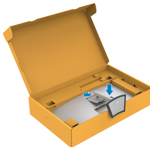
Figure 16. Insérer les languettes de la colonne du socle dans les fentes
