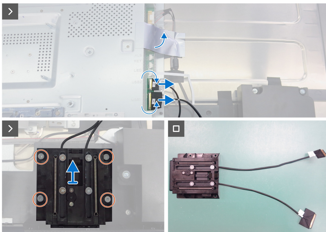
Figure 23. Retrait du module QAP
