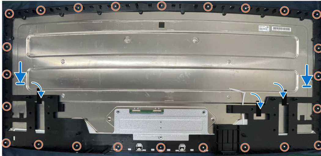
Figure 34. Installation du cadre intermédiaire
