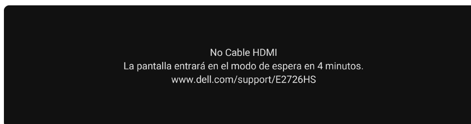
Figura 24. Mensaje de advertencia de cable HDMI desconectado
