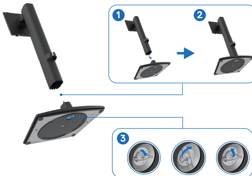
Figura 15. Collegamento della base
