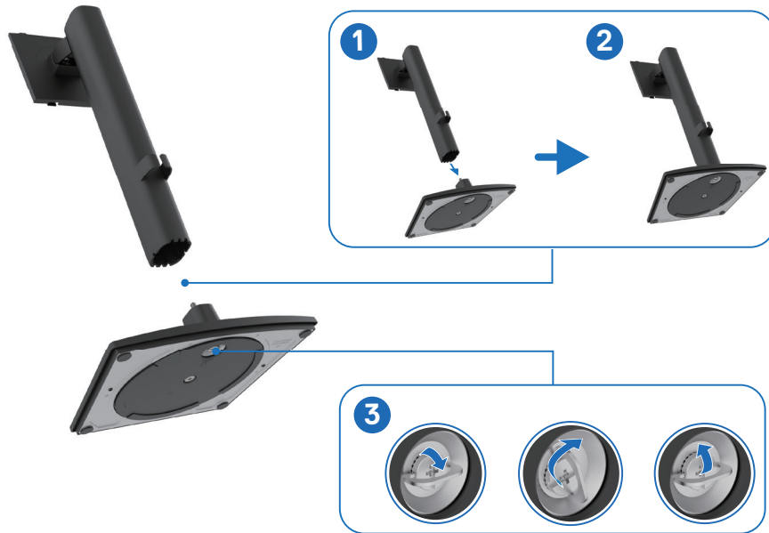
Abbildung 15. Montieren des Monitorständers
