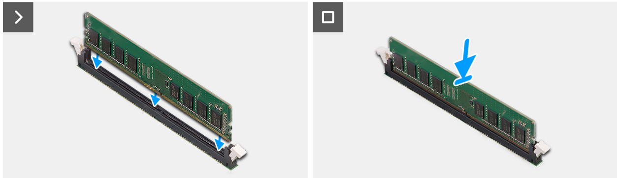
Abbildung 24. Einsetzen des Speichermoduls
