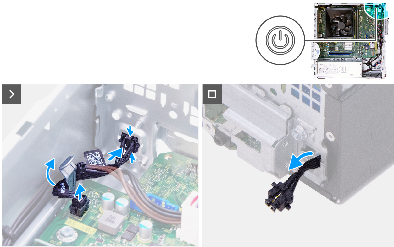
Abbildung 43. Entfernen des Netzschalters
