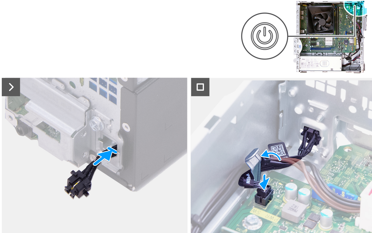
Abbildung 44. Installieren des Netzschalters
