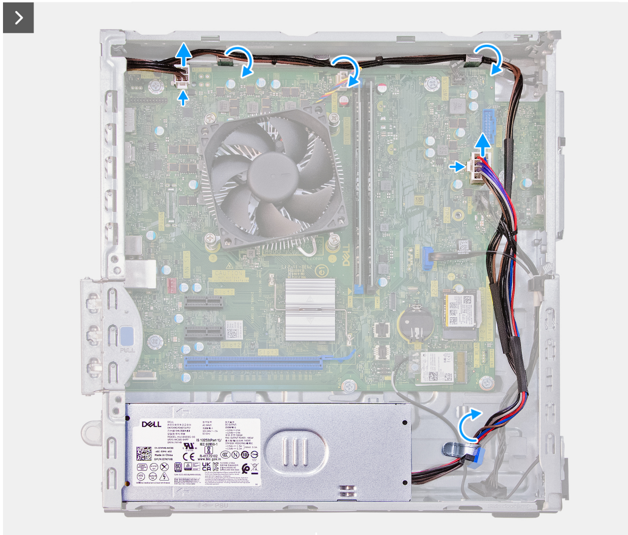
Abbildung 33. Entfernen der Stromversorgungseinheit
