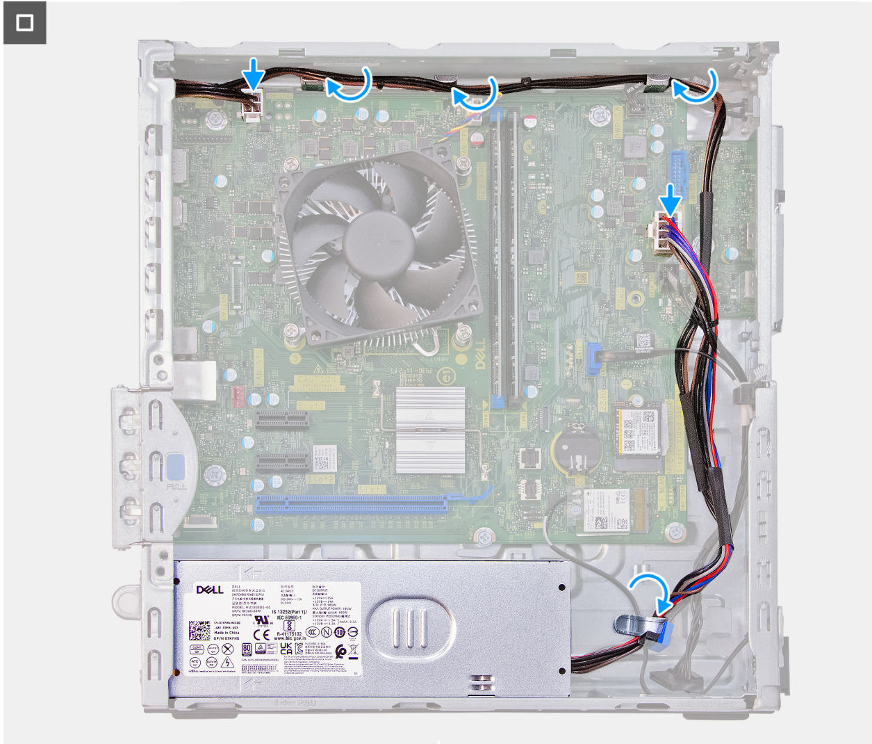
Abbildung 36. Installieren der Stromversorgungseinheit
