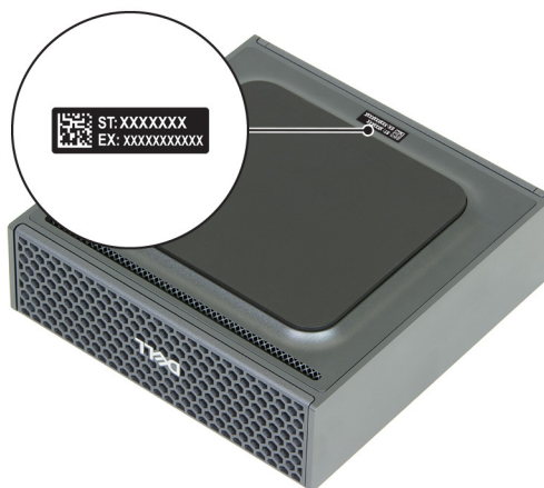
Ilustración 3. Ubicación de la etiqueta de servicio en la Dell Pro Max con GB10 FCM1253
