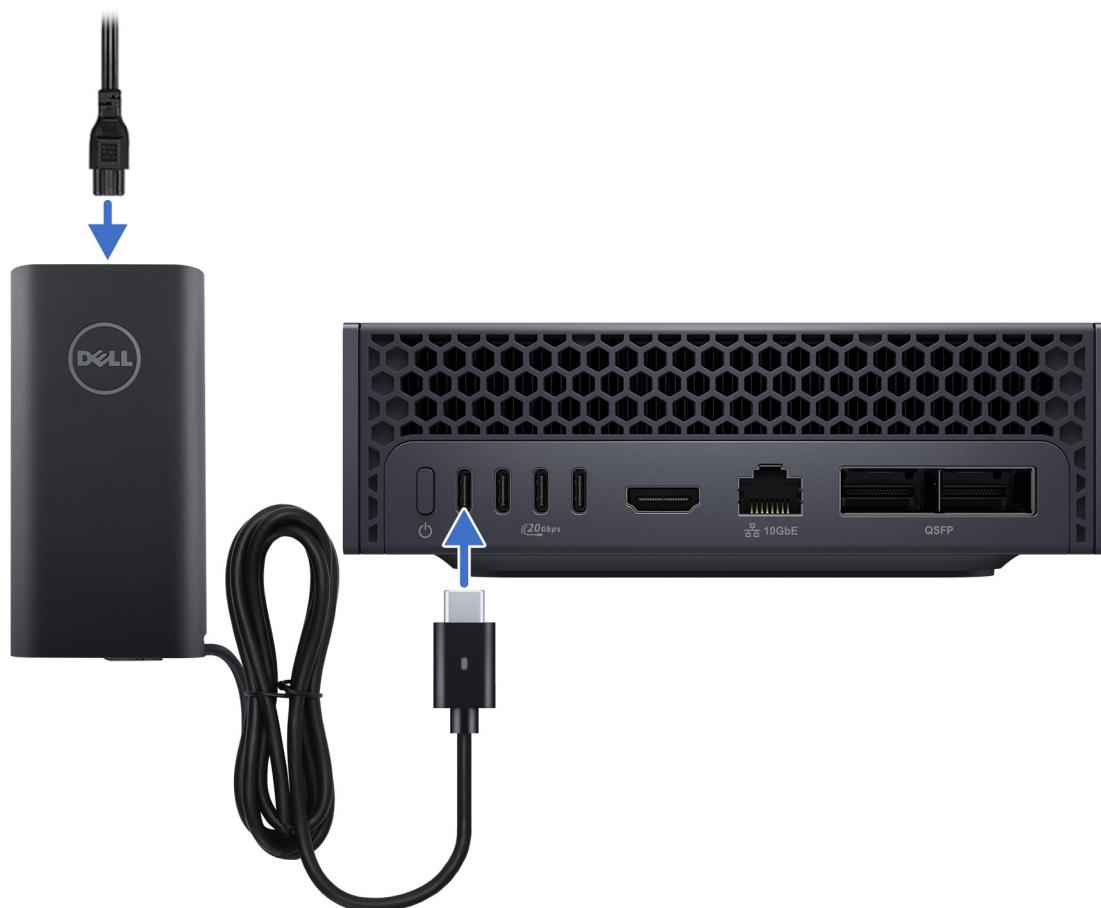
Ilustración 10. Conexión del adaptador de alimentación
