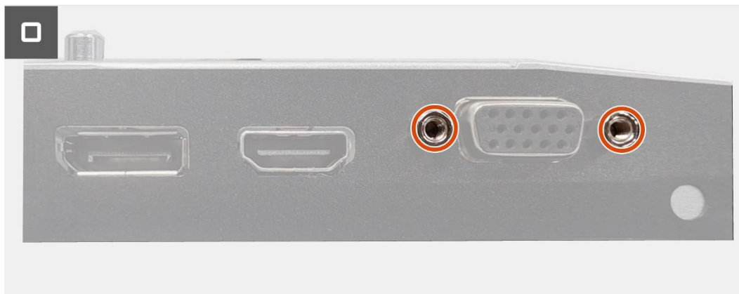
Figura 17. Instalación de la placa de interfaz
