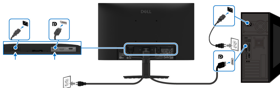
Figura 15. Conexión del cable DP
