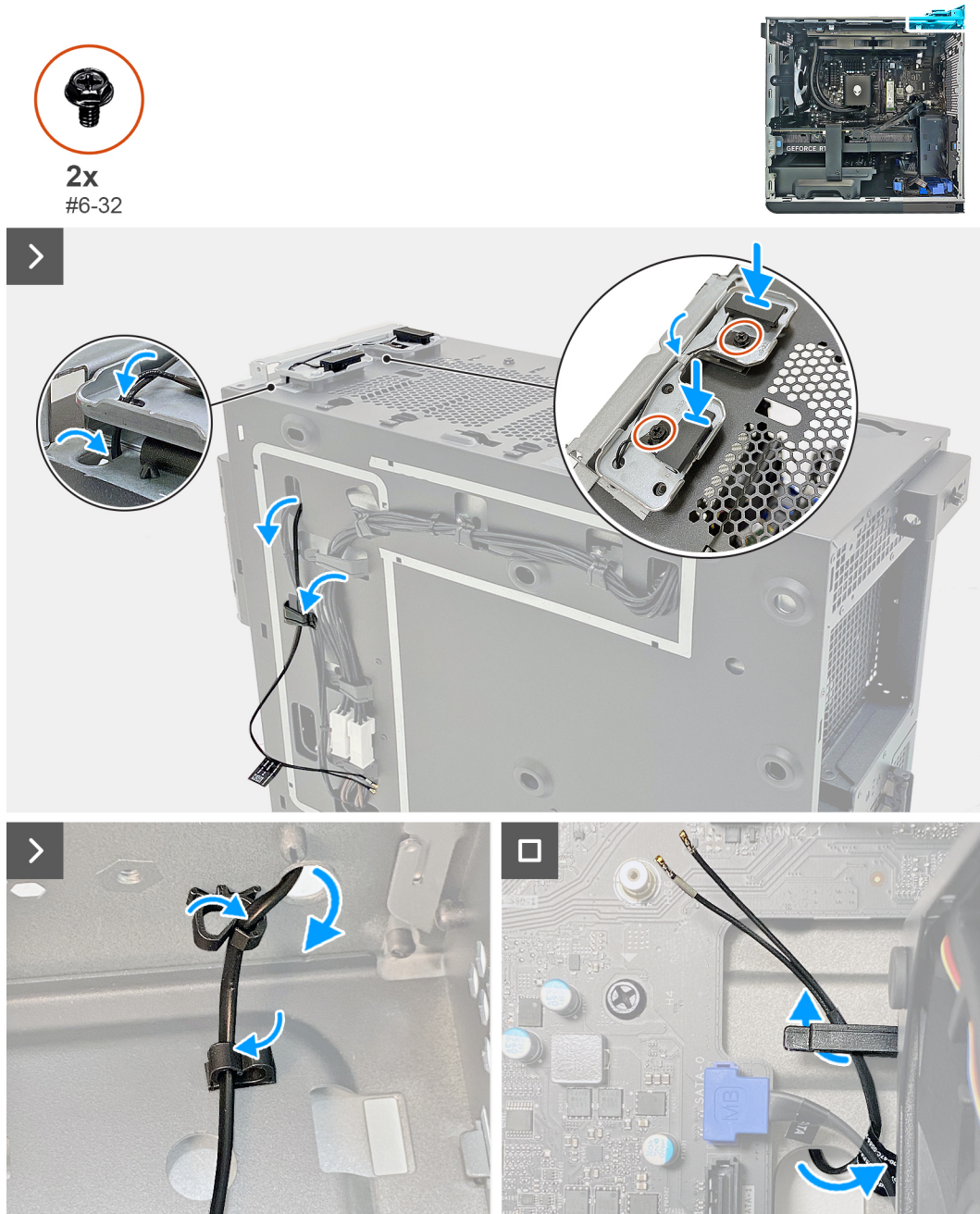
Ilustración 58. Instalación de la antena
