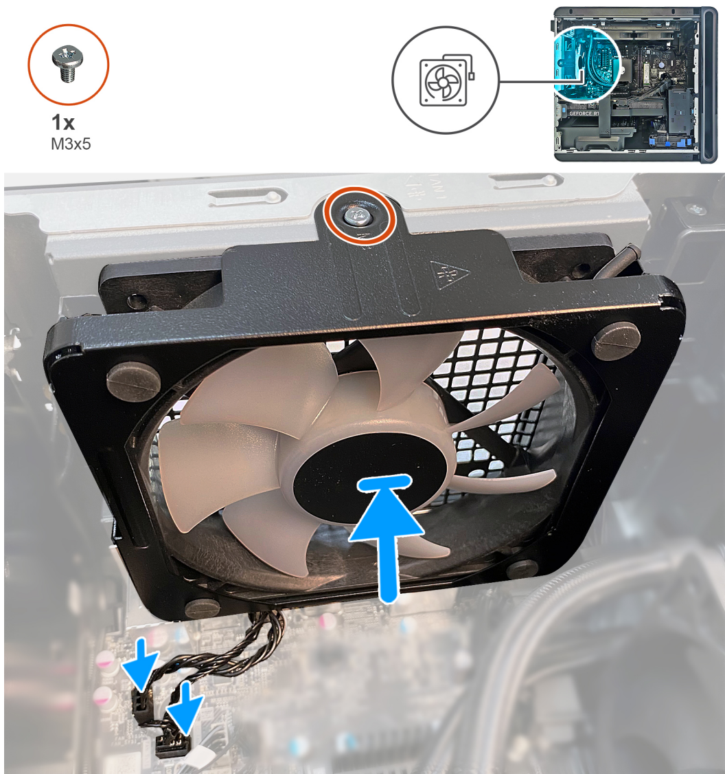
Ilustración 44. Instalación del ventilador del chasis posterior
