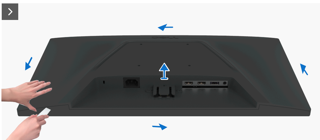
Rysunek 3. Zdejmowanie pokrywy tylnej
