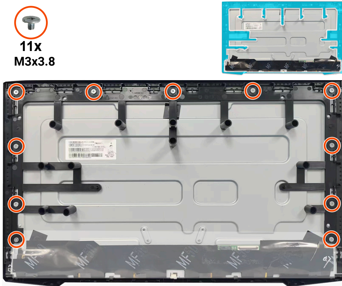
Rysunek 18. Instalacja ramki środkowej
