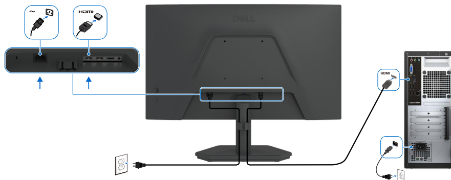
Figura 15. Conexión del cable HDMI
