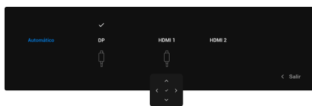
Figura 31. Selección automática de fuente de entrada
