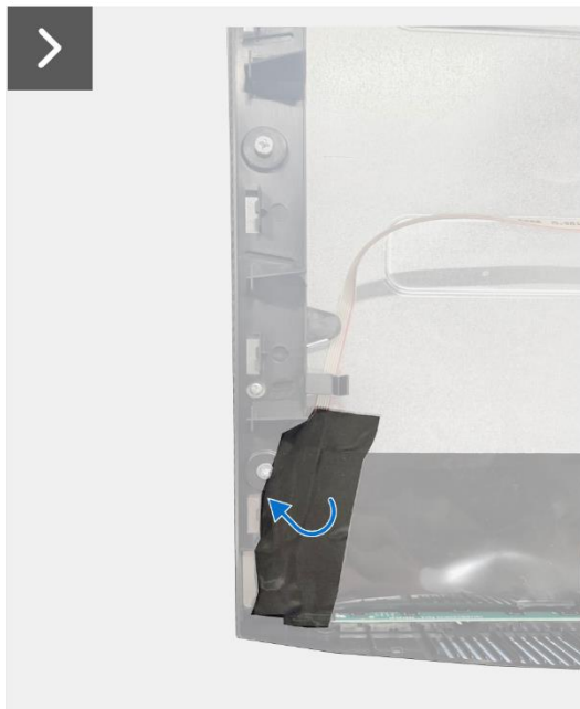
Figura 14. Desmontaje del conjunto del chasis
