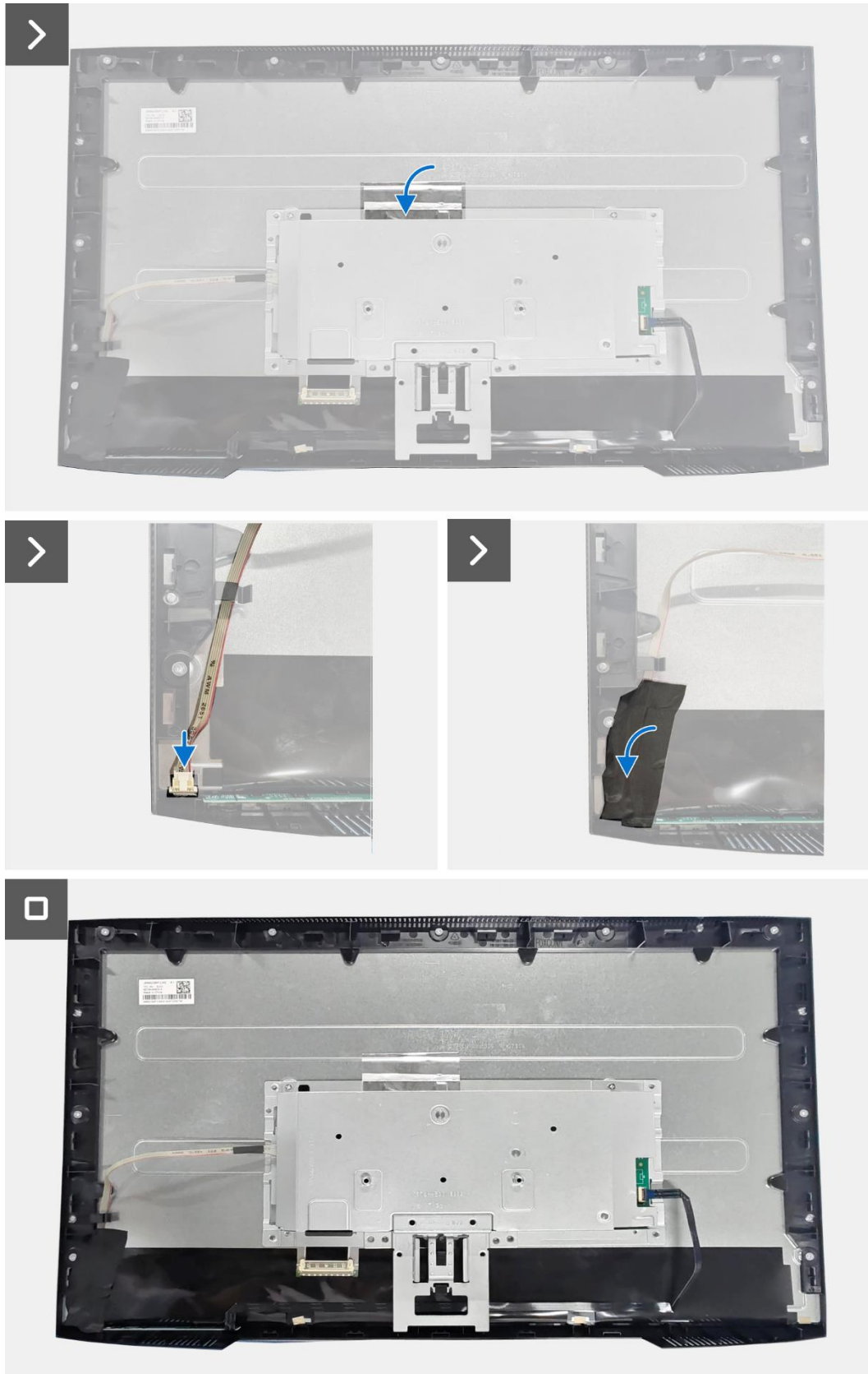
Figure 17. Installation de l'assemblage du châssis
