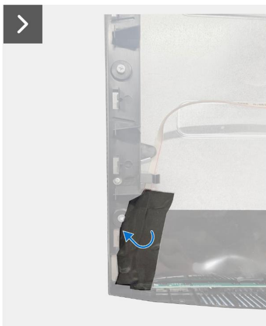
Obrázek 14. Demontáž sestavy šasi
