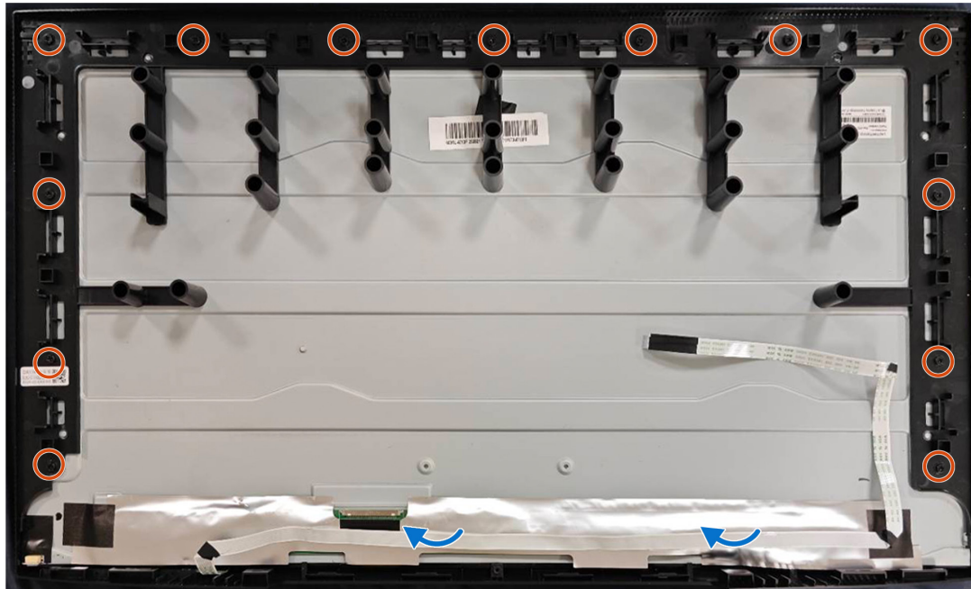
Figure 19. Installer le cadre central
