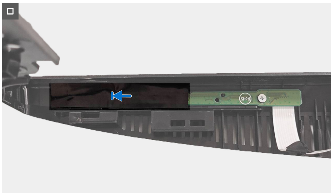
Obrázek 23. Instalace desky klávesnice
