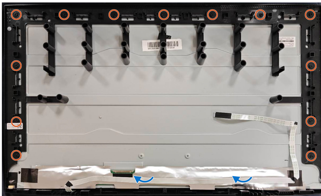
Obrázek 19. Instalace středního rámu
