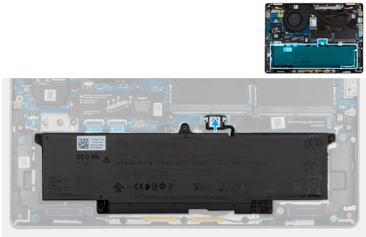
Abbildung 25. Verbinden des Akkukabels
