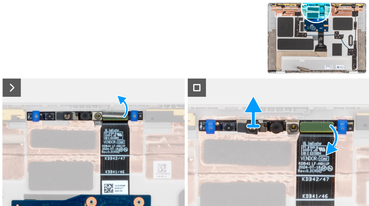
Abbildung 88. Entfernen der MIPI-Kamera
