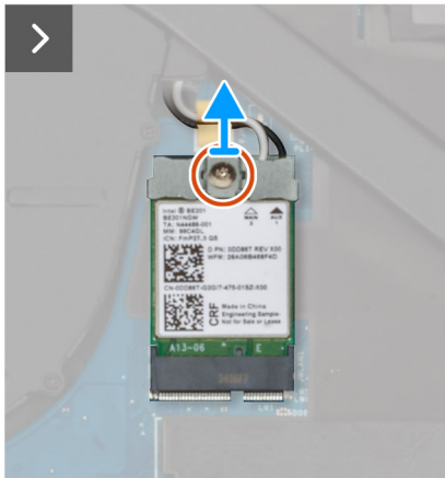
Abbildung 40. Entfernen der WLAN-Karte
