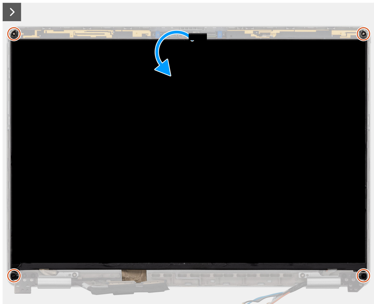
Abbildung 68. Entfernen des Bildschirms
