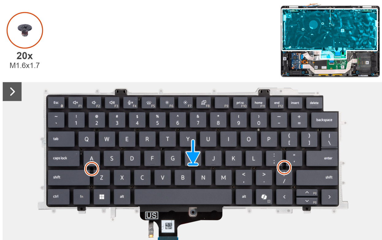
Abbildung 83. Einbauen der Tastatur
