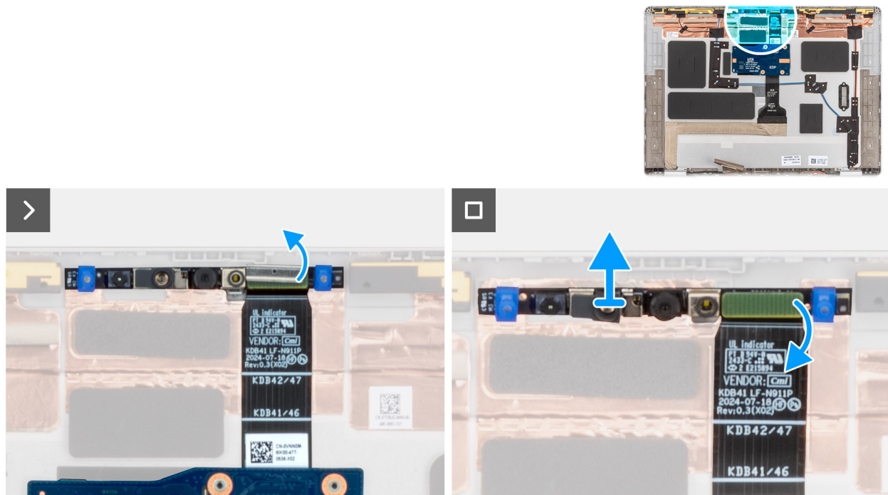
Abbildung 77. Entfernen der MIPI-Kamera
