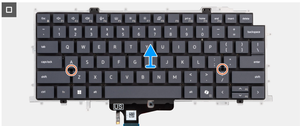
Abbildung 82. Entfernen der Tastatur
