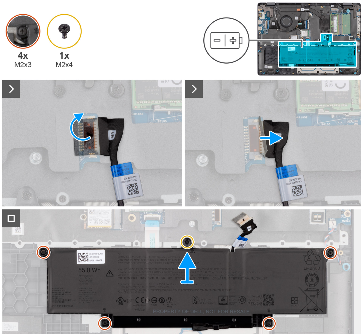
Abbildung 17. Entfernen des Akkus
