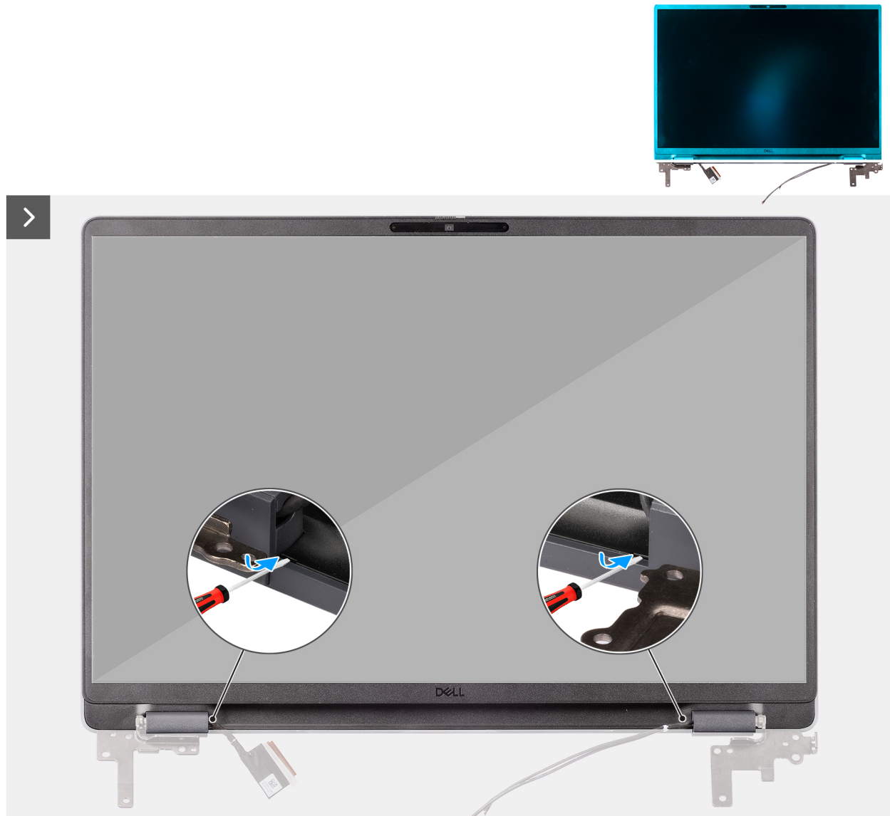
Abbildung 98. Entfernen der Bildschirmblende
