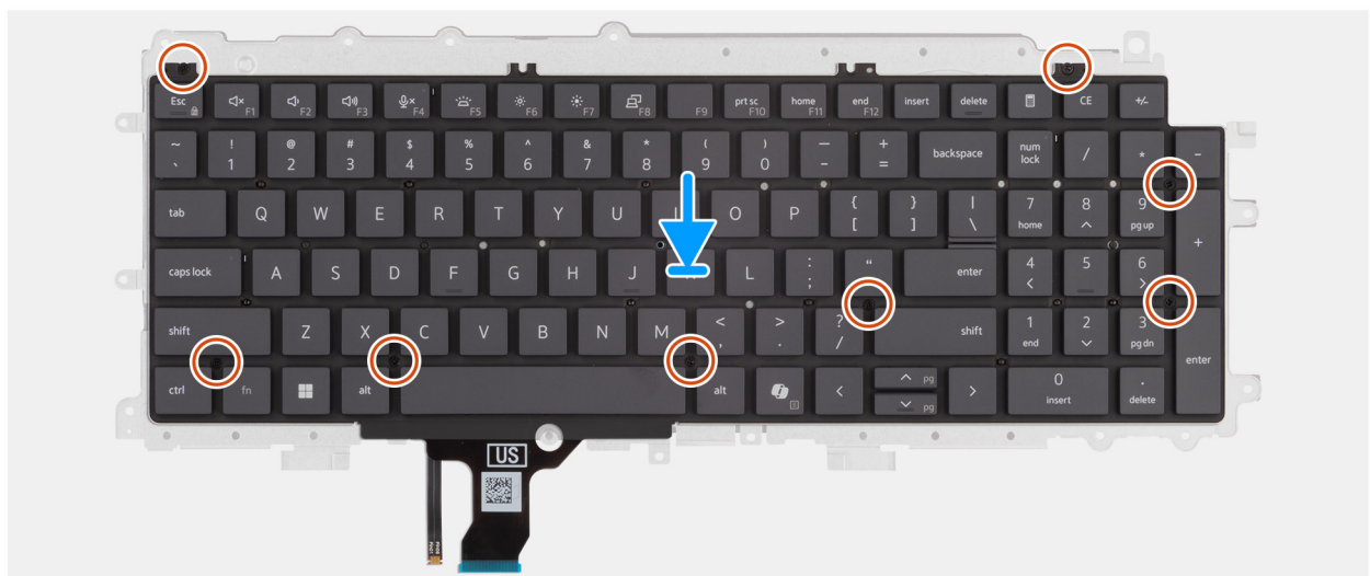
Abbildung 88. Einbauen der Tastaturauflege
